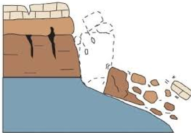
Slika 2.2: Tip nestabilnosti kosine - prevrtanje [1]
