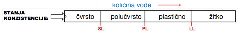
Slika 2.2: Stanja konzistencije i granice vlažnosti [5]
