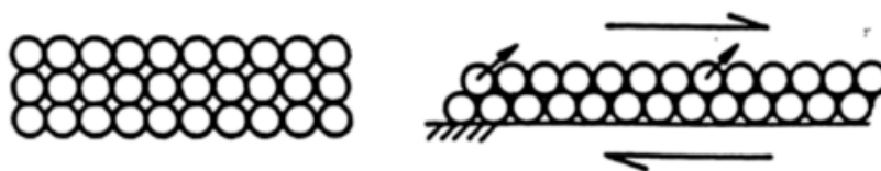
Slika 2.5: Skica pomaka čestica: (a) rahlo stanje, (b) zbijeno stanje, prema [8]
