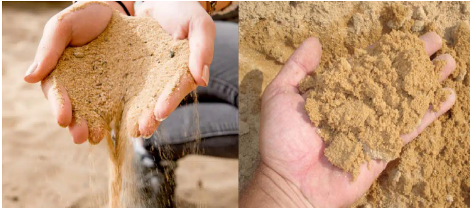
Slika 2.4: Prikaz nekoherentnih i koherentnih tla [7]
