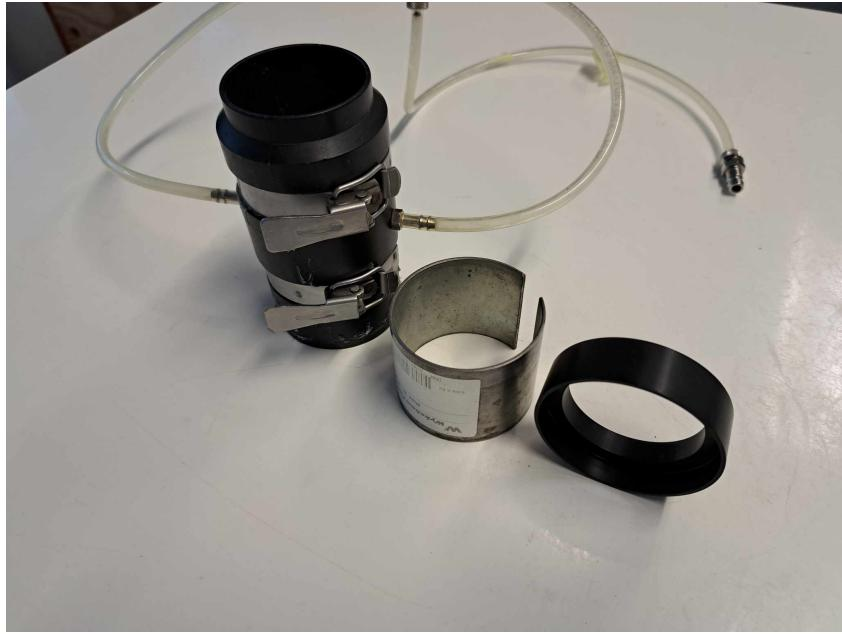
Slika 4.5: Prikaz kalupa sa cijevima za usis, pored kojeg su metalni obruč za nemještanje O - ringova i kapa za ugradnju zadnjeg sloja materijala
