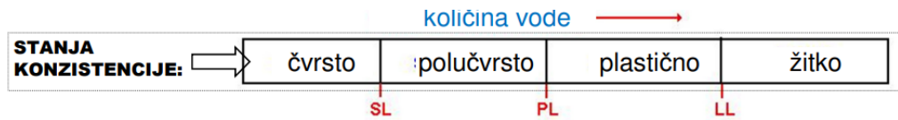
Slika 2.2: Stanja konzistencije i granice vlažnosti [5]
