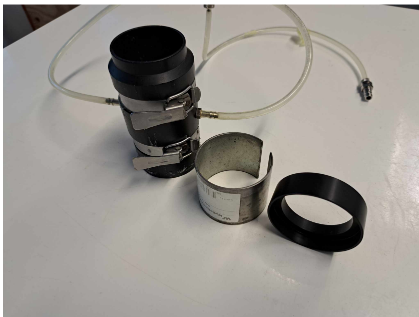
Slika 4.5: Prikaz kalupa sa cijevima za usis, pored kojeg su metalni obroč za nemještanje O - ringova i kapa za ugradnju zadnjeg sloja materijala
