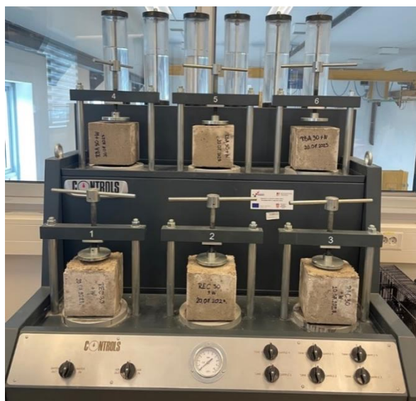
Slika 14: Uređaj za ispitivanje dubine prodora vode u beton (Autor: Matija Budić)
