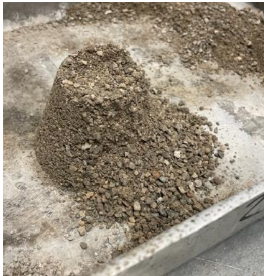
Slika 30: : Djelomično osipanje uzorka agregata (Autor: Matija Budić)
