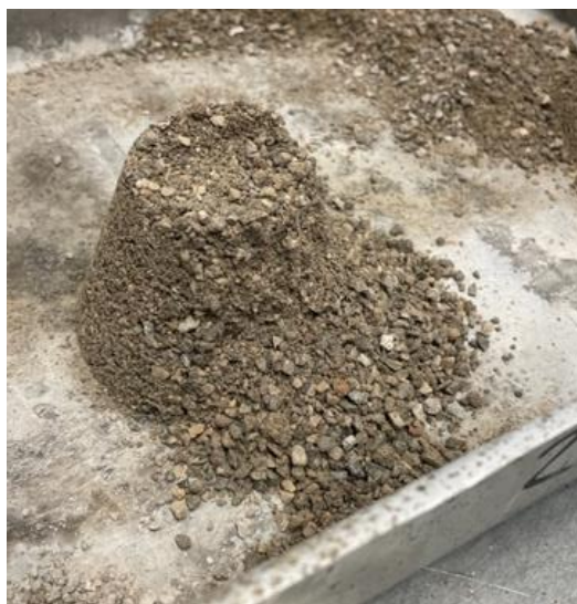
Slika 30: : Djelomično osipanje uzorka agregata (Autor: Matija Budić)
