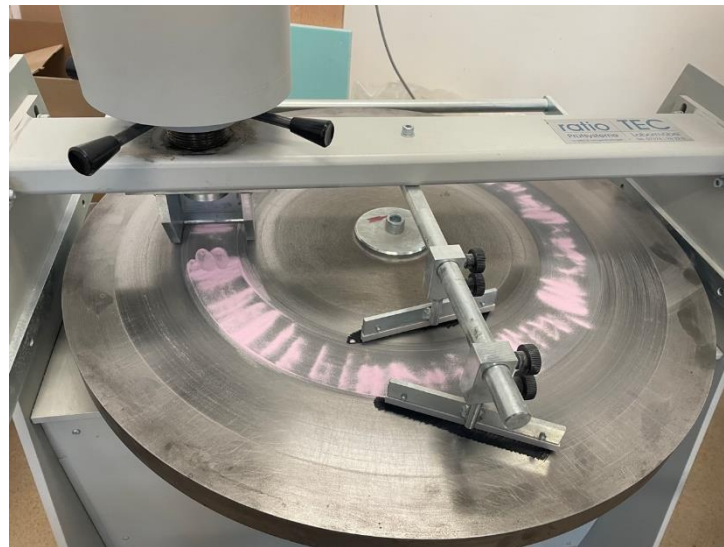
Slika 18: Raspoređeni kvarcni pijesak na rotacijskom stolu (Autor: Matija Budić)
