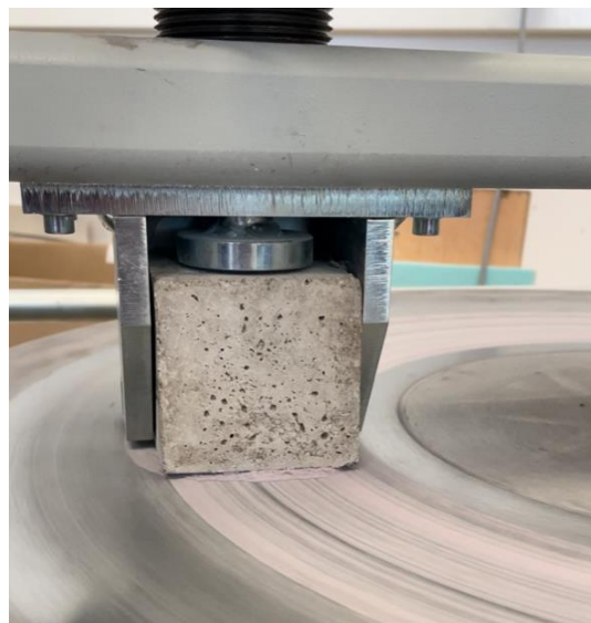
Slika 19: Postavljanje uzorka u metalno kućište i pokretanje rotacija (Autor: Matija Budić)
