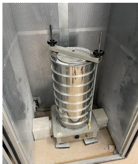
Slika 25: Sita u uređaju za prosijavanje agregata (Autor: Matija Budić)
