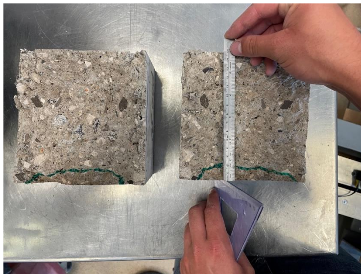
Slika 16: Označavanje i mjerenje dubine prodora vode (Autor: Matija Budić)
