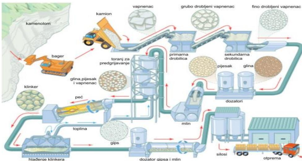
Slika 6. Moderni postupak pri proizvodnji cementa [1]
