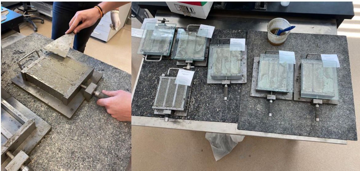
Slika 19. Cementni mort u kalupima
