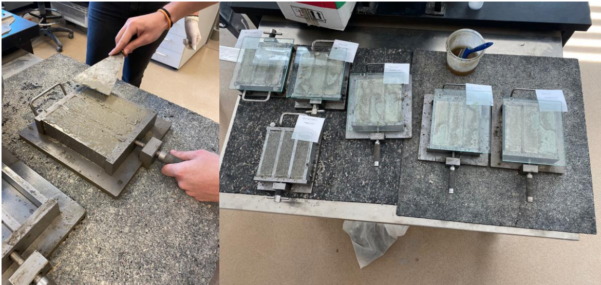
Slika 19. Cementni mort u kalupima
