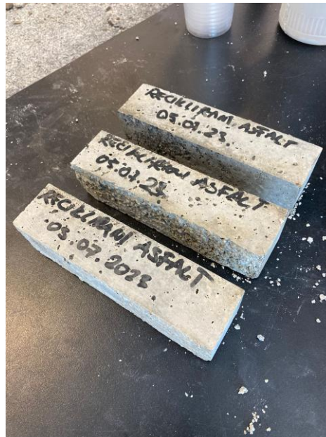
Slika 23. Prizme s agregatom od recikliranog asfalta
