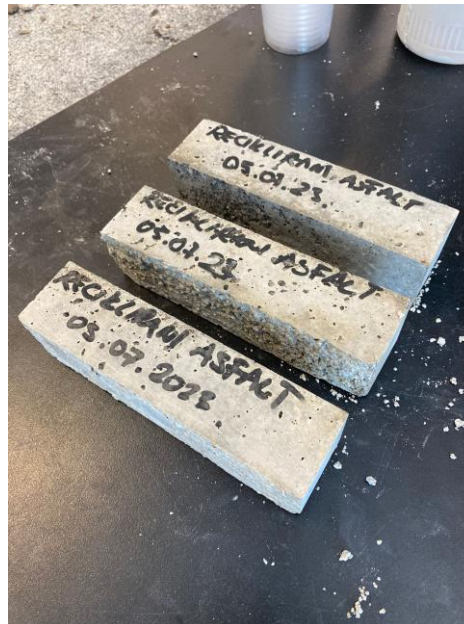
Slika 23. Prizme s agregatom od recikliranog asfalta
