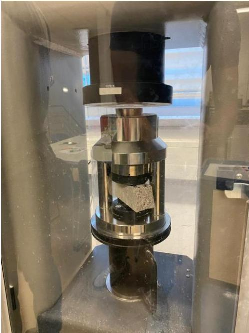
Slika 30. Ispitivanje tlačne čvrstoće
