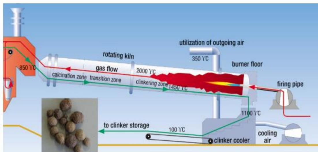
Slika 3. Proces proizvodnje klinkera u rotacijskoj peći [1]
