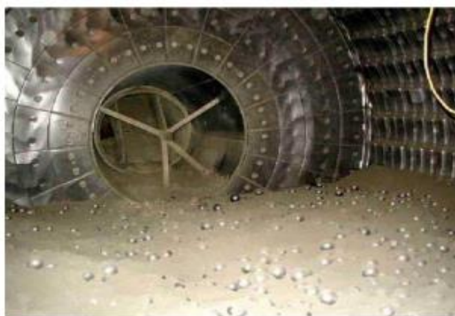
Slika 4. Mljevenje klinkera, unutrašnjost mlina s kuglama [1]
