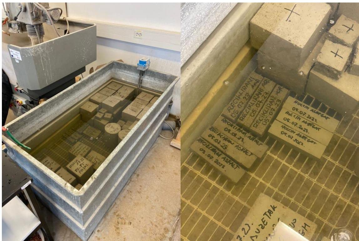
Slika 24. Voden basen za sazrijevanje cementnih prizmi
