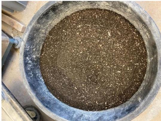
Slika 17. Agregat reciklirani asfalt
