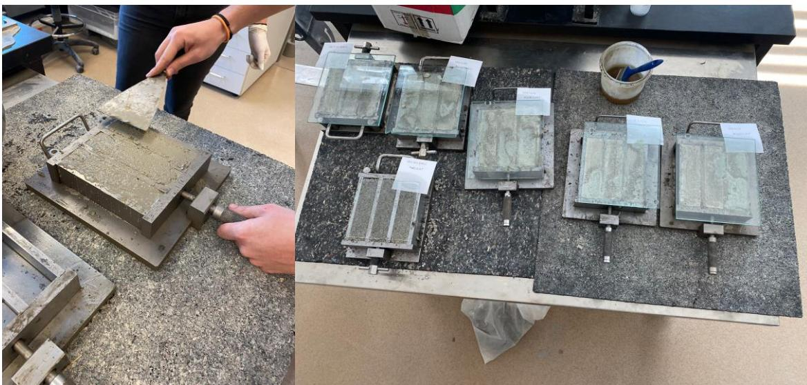
Slika 19. Cementni mort u kalupima
