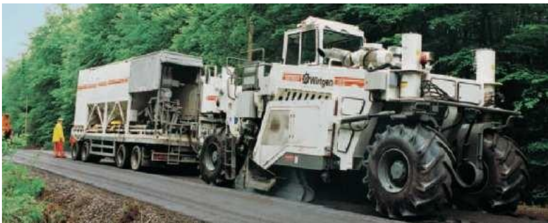
Slika 12: Mehancizacija za izradu hladne reciklaže, modeli WR 2500 i WM 400
