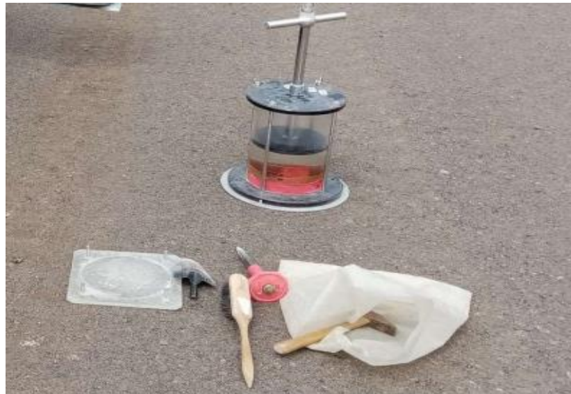
Slika 25. Utvrđivanje stupnja zbijenosti volumetrom
