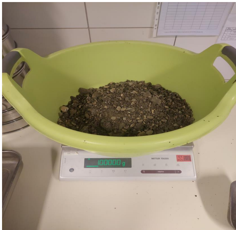
Slika 9: Asfaltni materijal postojeće konstrukcije nakon glodanja
