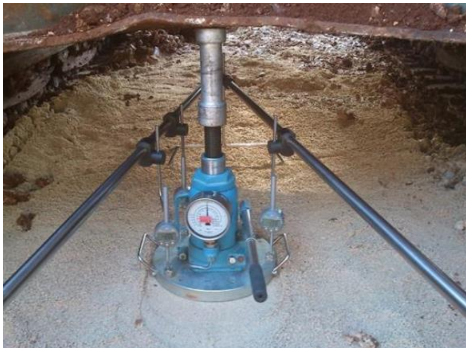
Slika 23: Ispitivanje modula stišljivosti kružnom pločom
