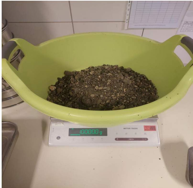
Slika 9: Asfaltni materijal postojeće konstrukcije nakon glodanja
