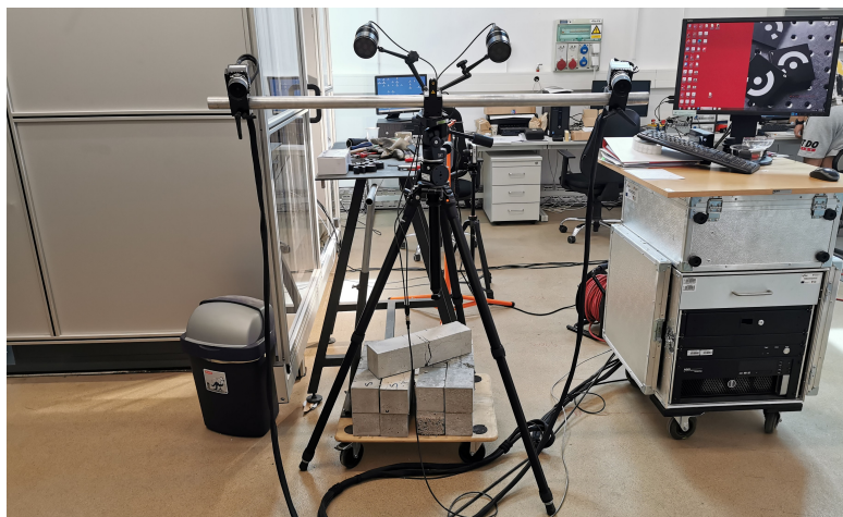
Slika 5.6: Optički mjerni sustav GOM Aramis 4M [5]
