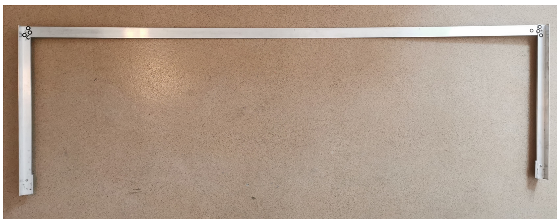
Slika 5.2: Fizikalni model okvira s krutim stupovima
