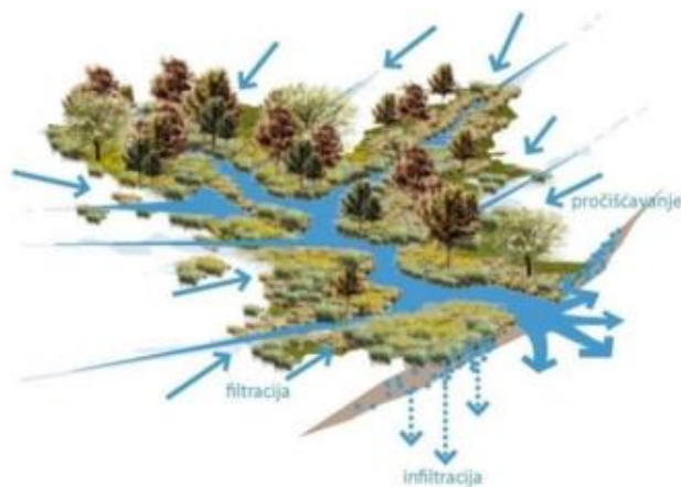
Slika 5: Integralni pristup odvodnje oborinske vode [4]
