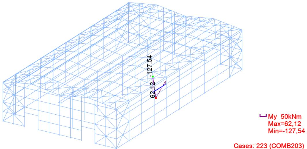
Slika 54. Položaj i vrijednosti dijagrama na kranskoj stazi mjerodavnoj za dimenzioniranje [izradio autor]
