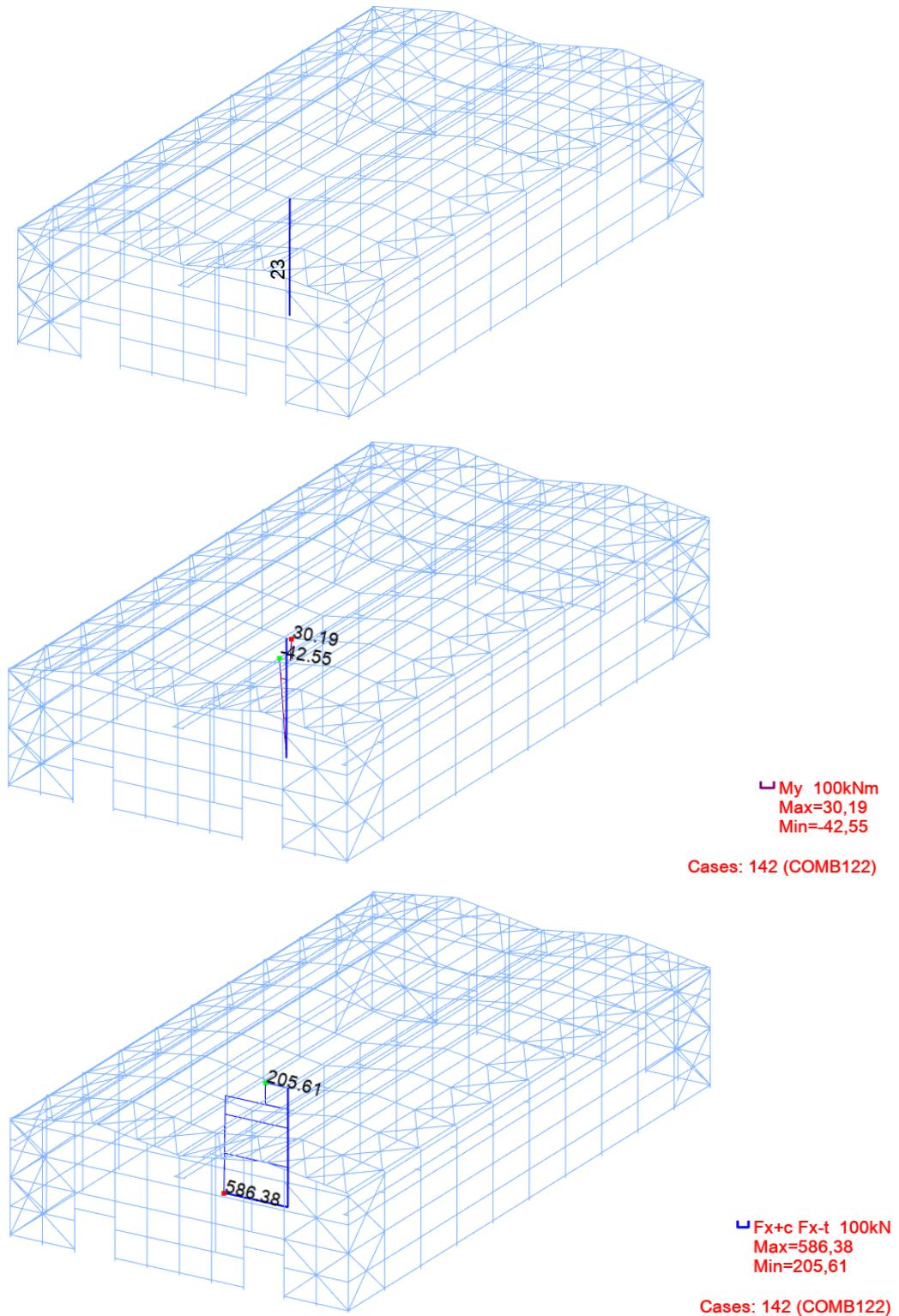
Slika 41. Položaj i vrijednosti dijagrama na unutarnjem stupu mjerodavnom za dimenzioniranje
