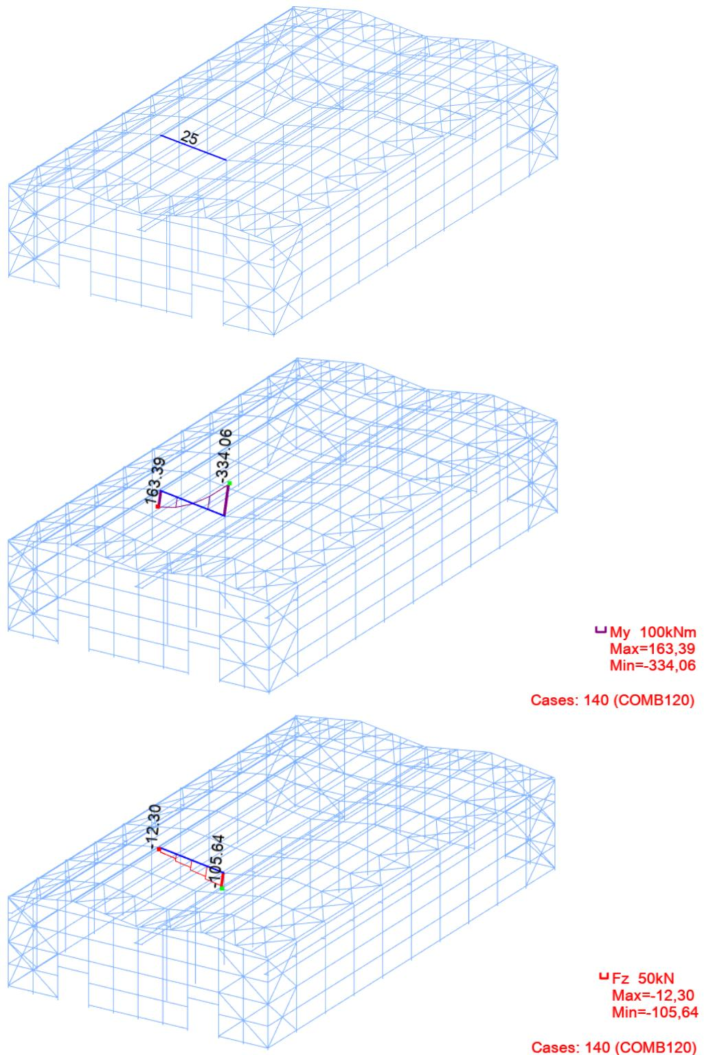
Slika 43. Položaj i vrijednosti dijagrama na grednom nosaču mjerodavnom za dimenzioniranje
