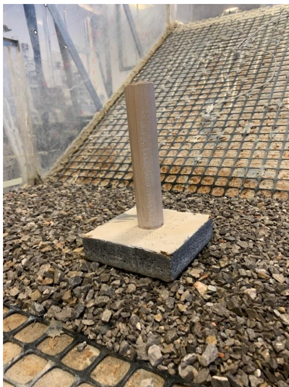
Slika 6. Ručni kompaktor korišten za zbijanje materijala.
