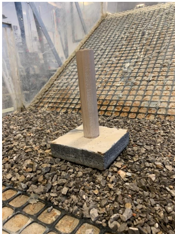
Slika 6. Ručni kompaktor korišten za zbijanje materijala.
