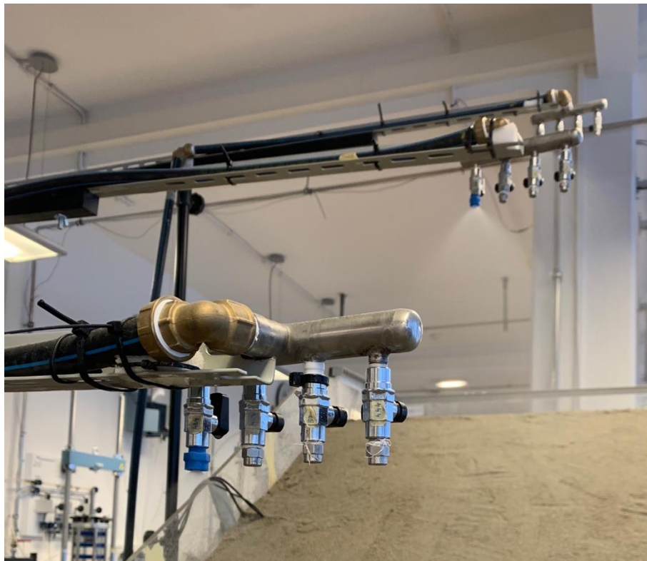
Slika 13. Grana simulatora s četiri mlaznice.
