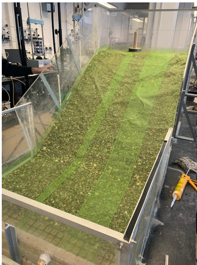
Slika 8. Geotekstil (membrana) postavljena na kontaktu slojeva.
