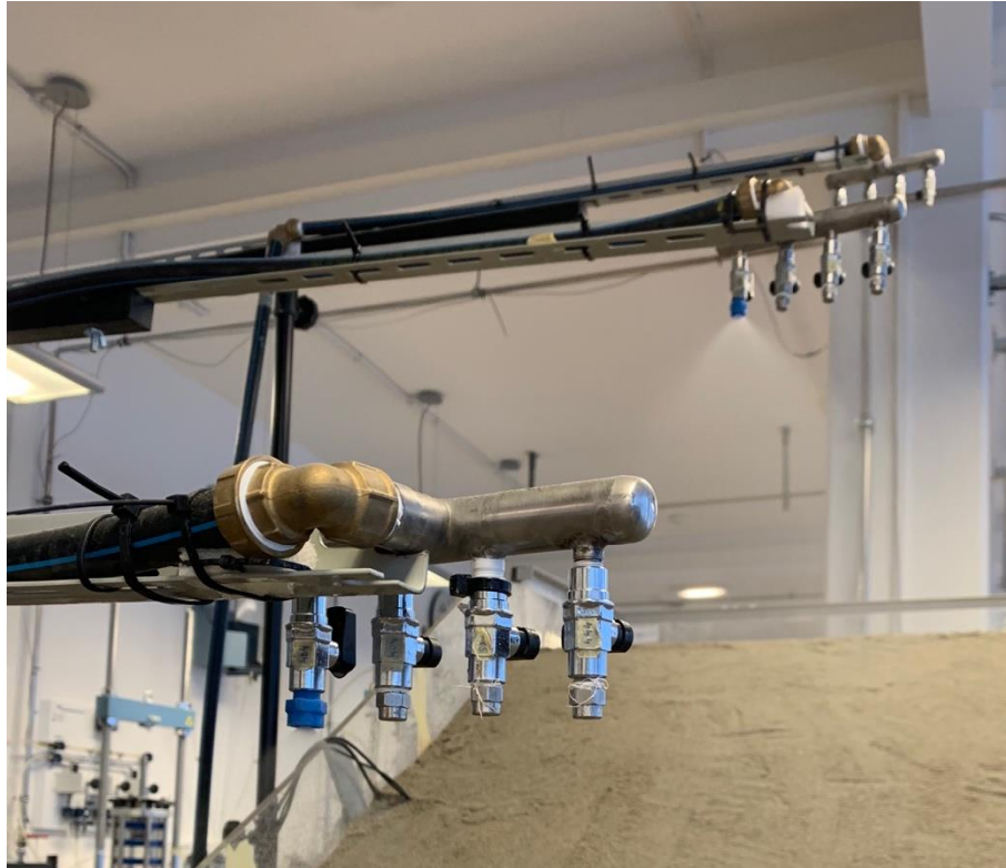
Slika 13. Grana simulatora s četiri mlaznice.
