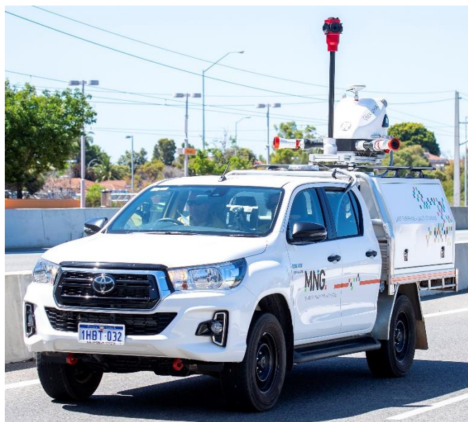
Slika 11: Mobilni laserski skener [31]
