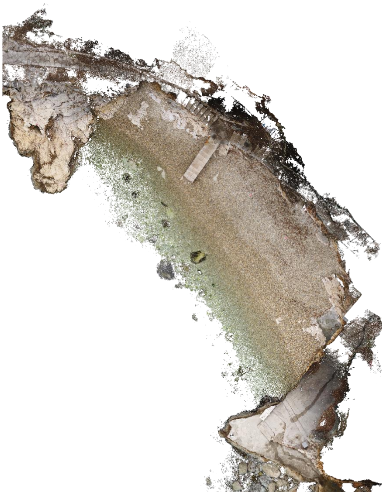
Slika 63: Ortofoto modela dobivenog UAV-SfM metodom
