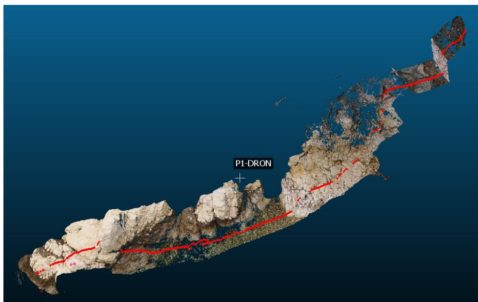
Slika 101: Prikaz presjeka 1 u CloudCompare -u – UAV-SfM metoda
