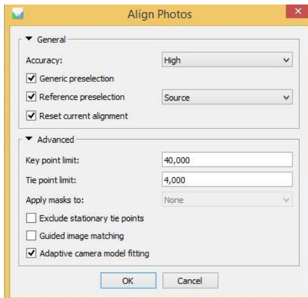
Slika 19: Parametri za povezivanje fotografija u Agisoft Metashape softveru
