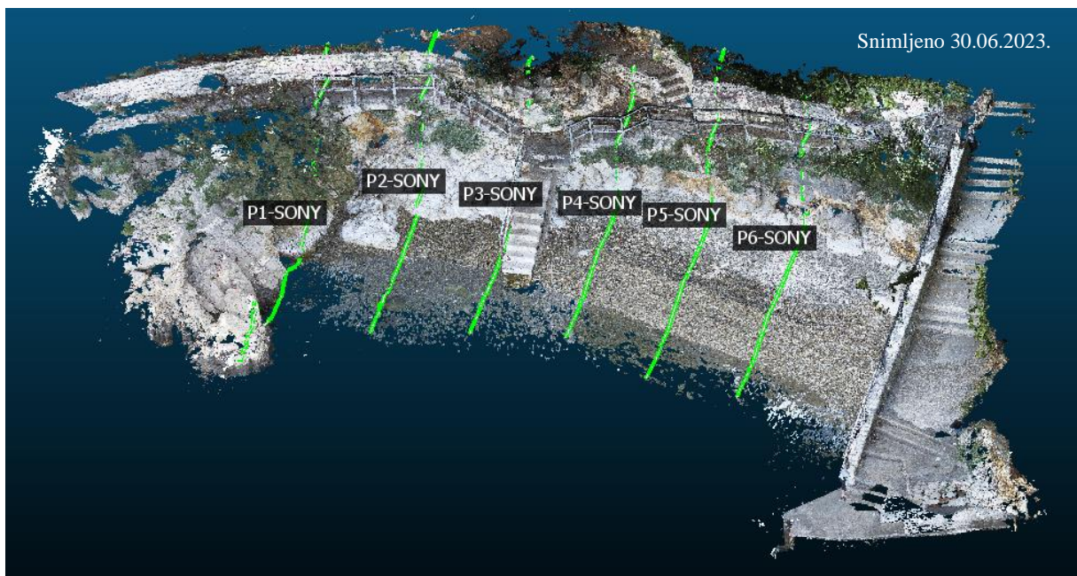
Slika 69: Poprečni presjeci na oblaku točaka dobivenim SfM metodom iz ruke - pogled 1
