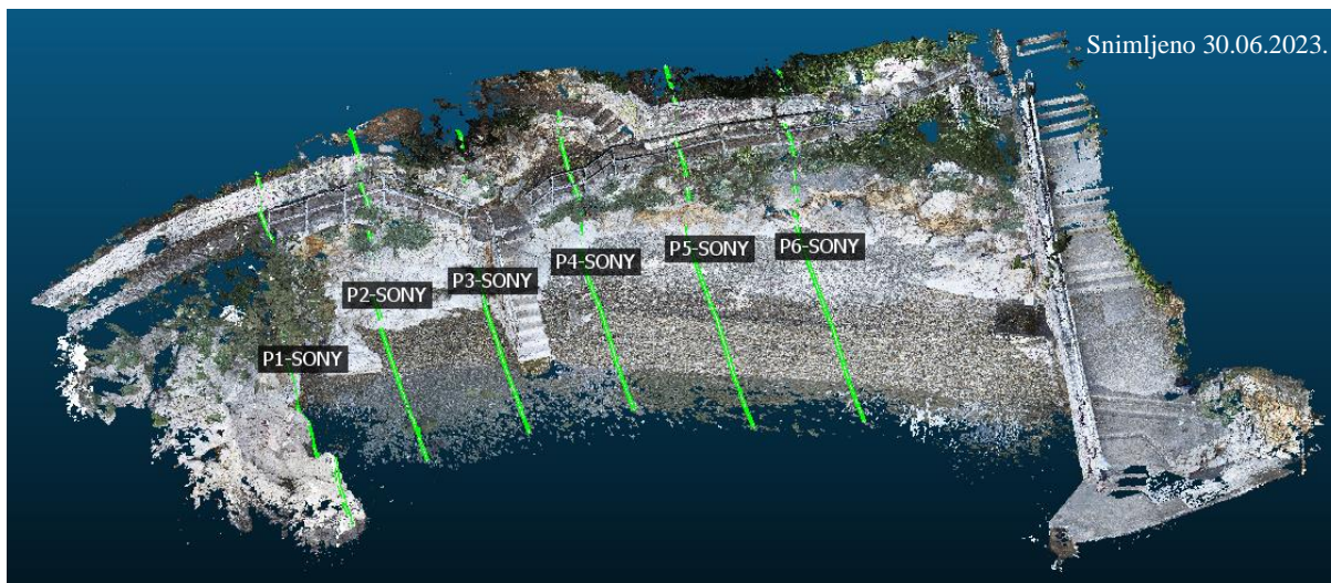
Slika 70: Poprečni presjeci na oblaku točaka dobivenim SfM metodom iz ruke - pogled 2
