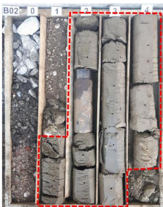
Slika 34: Log bušotine - prikaz gornjeg horizonta tvrde gline [34]
