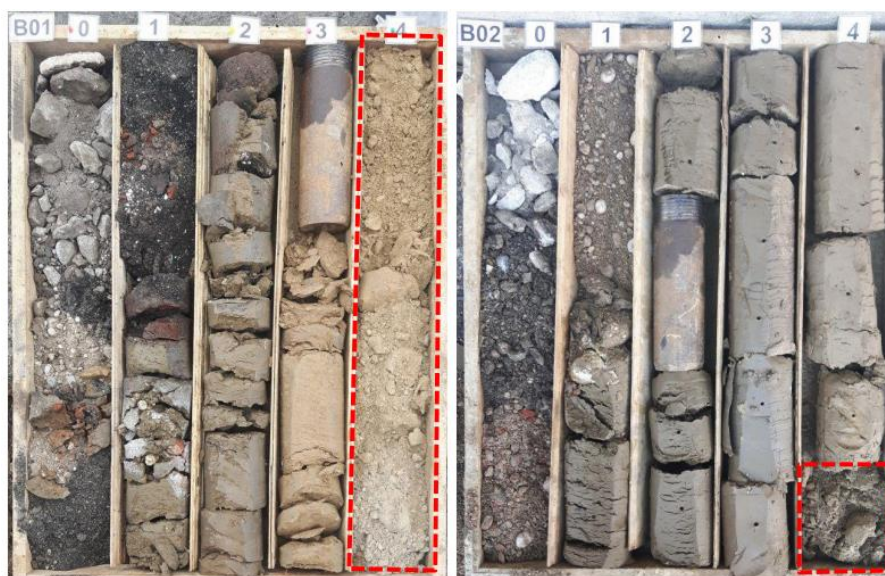
Slika 32: Log bušotine - prikaz pijeska [34]
