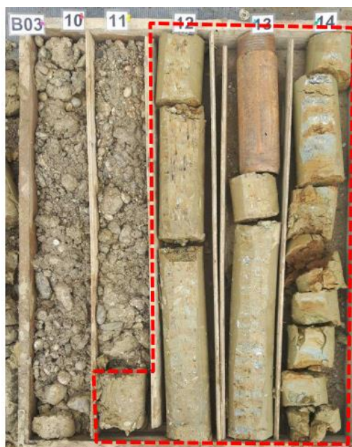
Slika 35: Log bušotine - prikaz donjeg horizonta tvrde gline [34]
