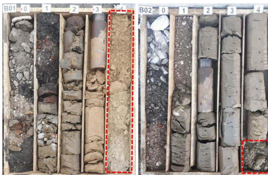
Slika 32: Log bušotine - prikaz pijeska [34]
