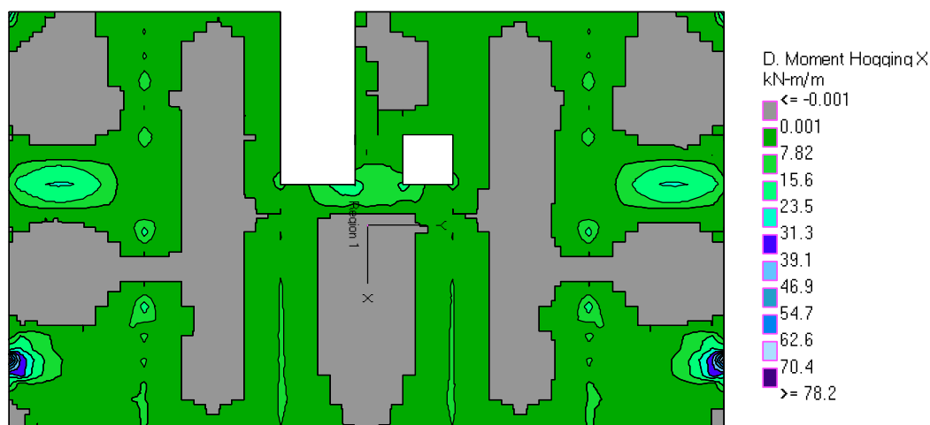
Slika 22. Prikaz momenta savijanja u gornjoj zoni za X smjer
