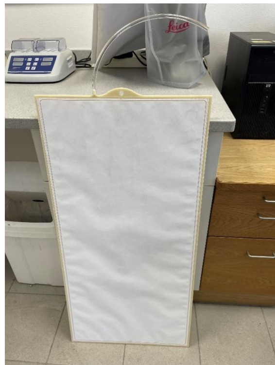
Slika 23. Pločasta membrana (vlastita fotografija)
