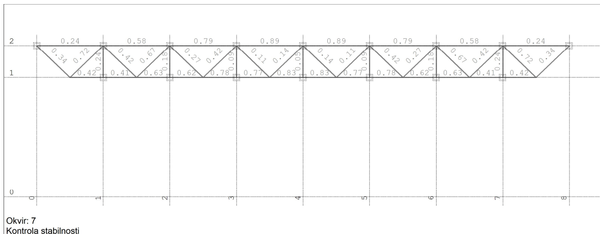
Slika 50. Iskoristivost elemenata glavne konstrukcije - okvir 7 (Tower 8 Professional)
