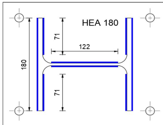
Slika 41: Nacrt pozicija zavara
