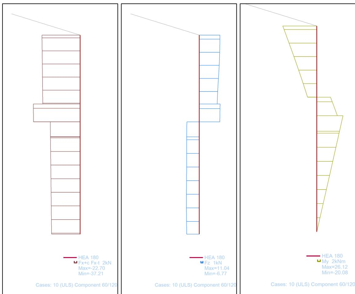
Slika 27: Dijagrami unutarnjih sila na stupu
