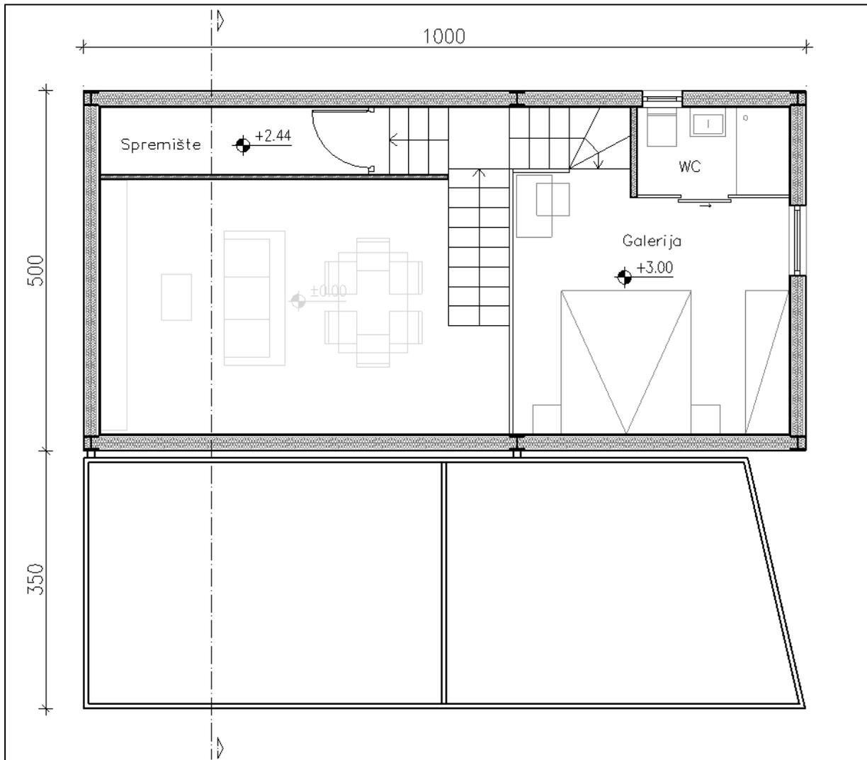
Slika 2: Arhitektonske podloge, Tlocrt prvog kata m 1:100
