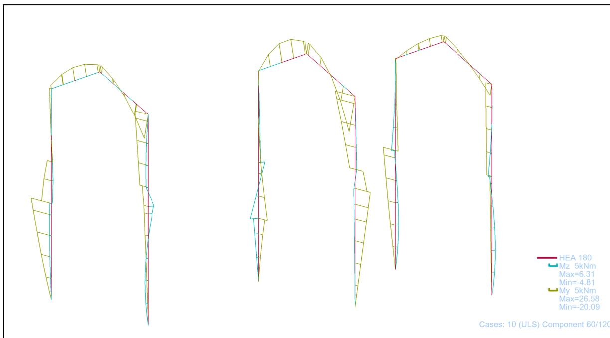
Slika 22: Dijagram momenata na glavnoj nosivoj konstrukciji [kN/m]
