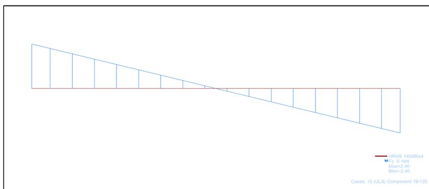
Slika 44: Dijagram poprečnih sila [kN]
