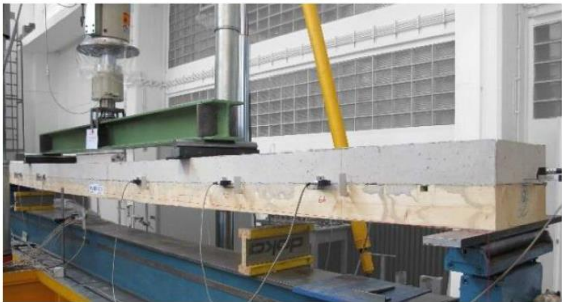
Slika 33. Laboratorijsko ispitivanje velikih uzoraka sa zasječenim spojevima [33]
