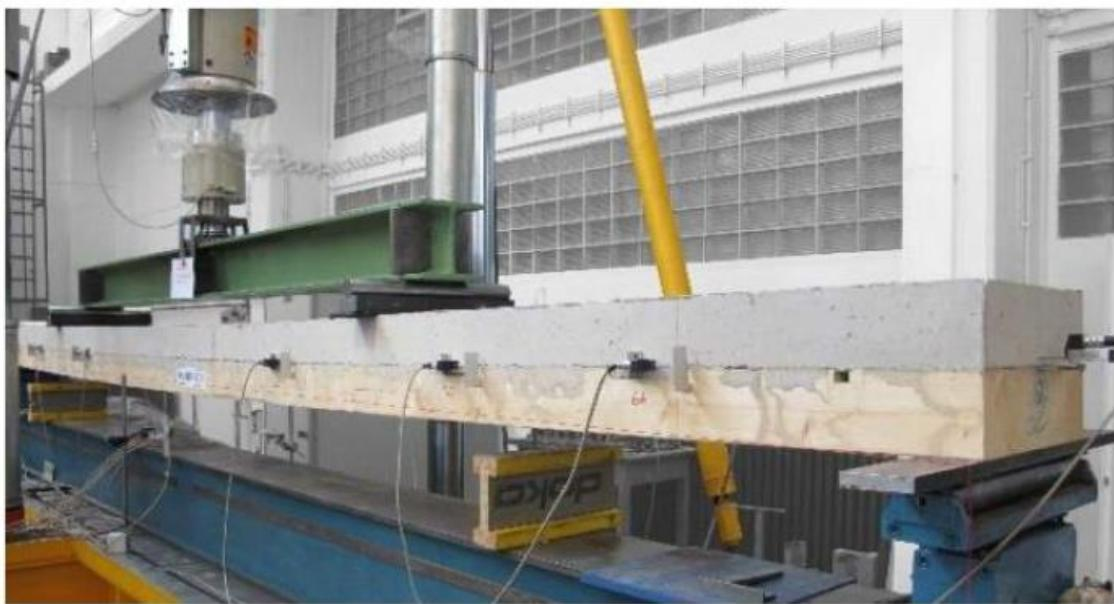
Slika 33. Laboratorijsko ispitivanje velikih uzoraka sa zasjećenim spojevima [33]
