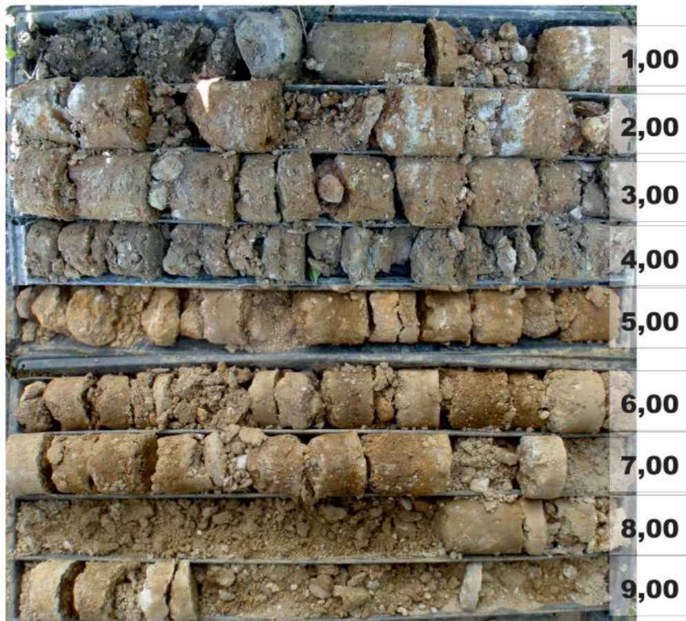
Slika 10. Jezgra bušotine B-2 (Geotehnički elaborat, 2014)
