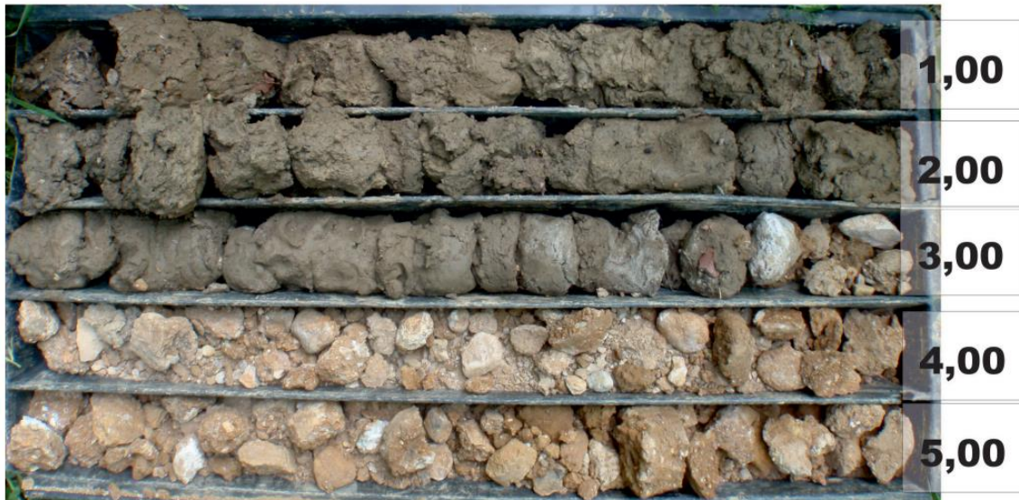
Slika 12. Jezgra bušotine B-4 (Geotehnički elaborat, 2014)
