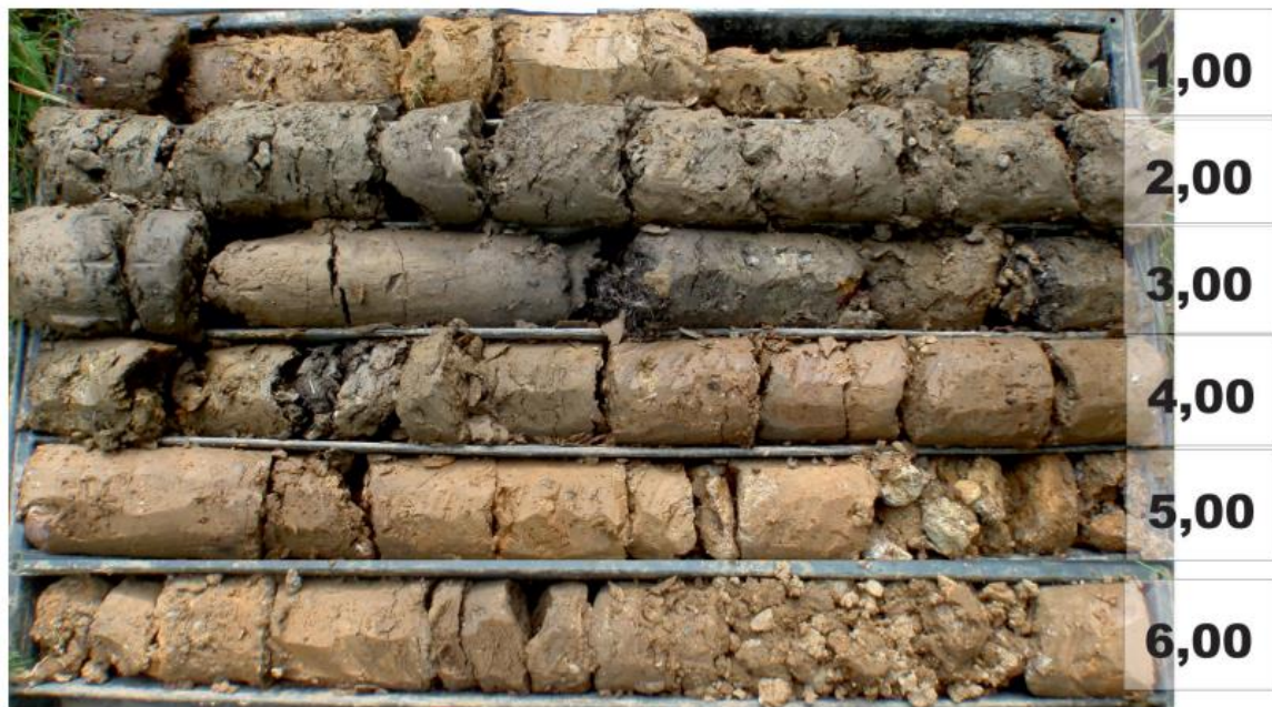
Slika 11. Jezgra bušotine B-3 (Geotehnički elaborat, 2014)
