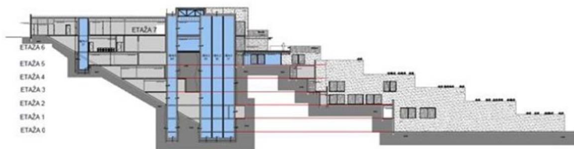
Slika 9. Presjek kroz dizala, projekt rekonstrukcije, 2013. Studio 92 d.o.o., Labin
