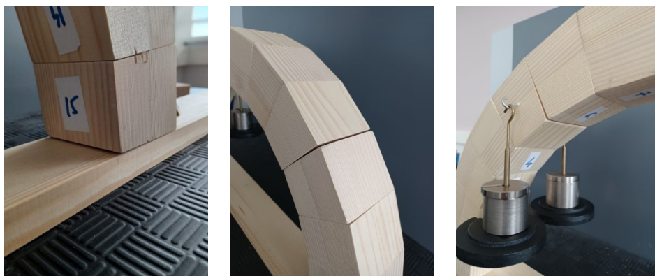
Slika 11. Detalj otvaranja zglobova pri sili F=23\text{ N} [6]
