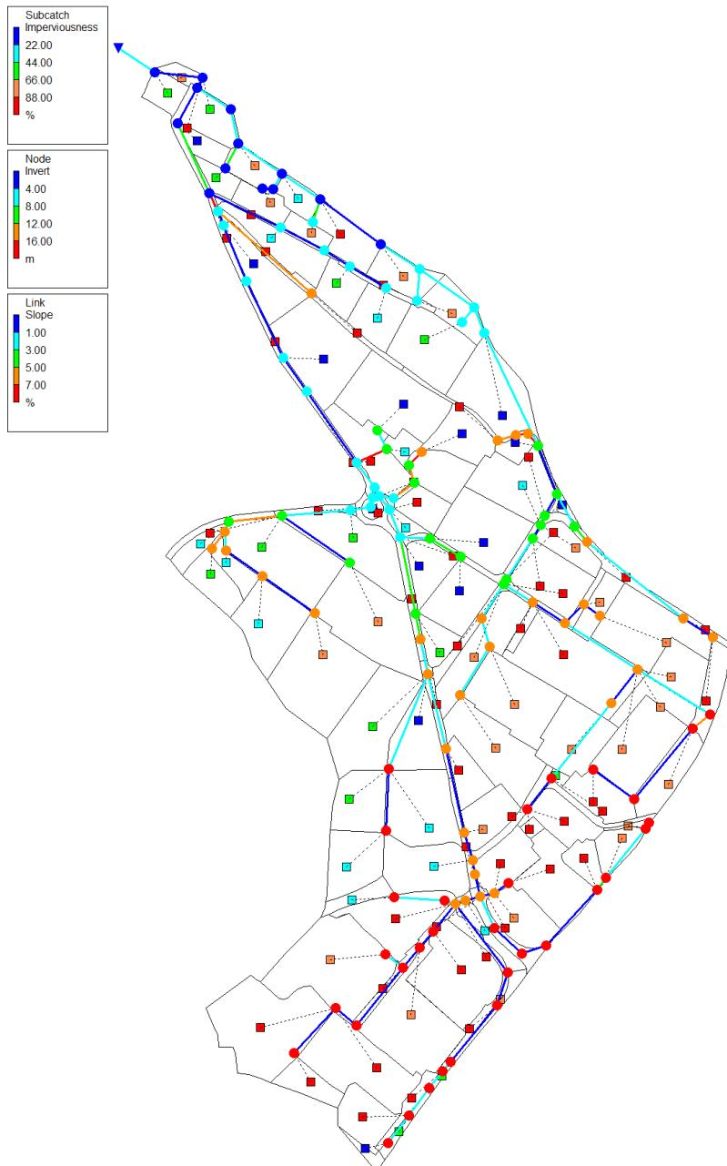
**Slika 6.** Matematički model sustava odvodnje oborinskih voda predmetnog sliva izrađen u SWMM računalnom programu s prikazom postotka nepropusnosti svakog podsliva (kvadrati), nadmorske visine dna okna (točke) i nagiba kolektora (linije).
