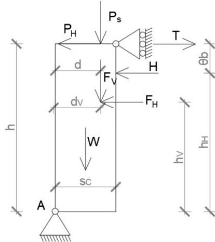
Slika 66. Shema potpornog zida (modificirano prema [1])
