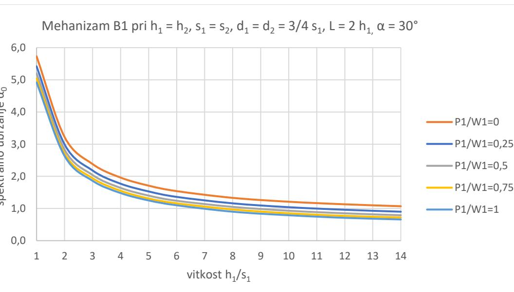
Slika 53. Spektralno ubrzanje za mehanizam B1 - slučaj 2
