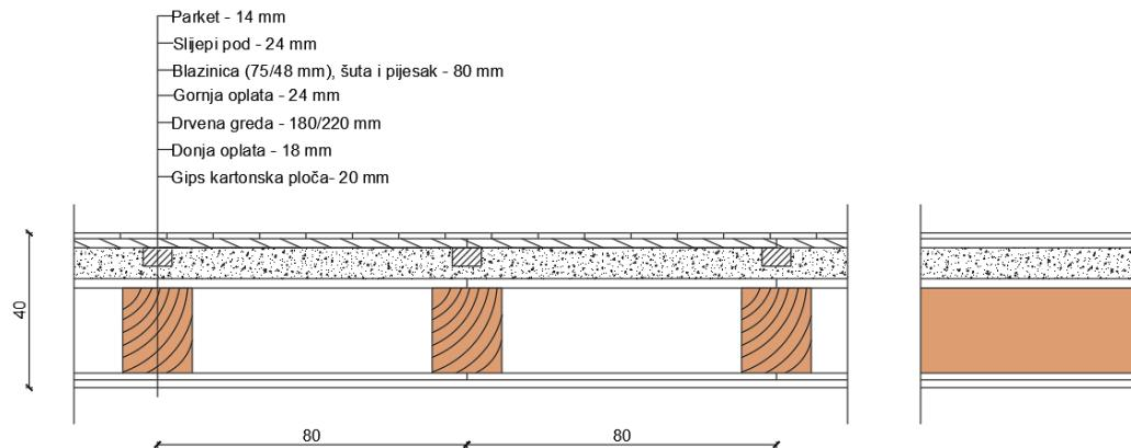
Slika 70. Prepostavljeni slojevi stropne konstrukcije
