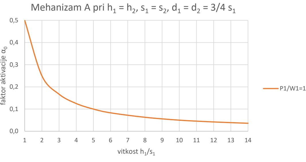
Slika 35. Faktor aktivacije za mehanizam otkazivanja A - slučaj 1
