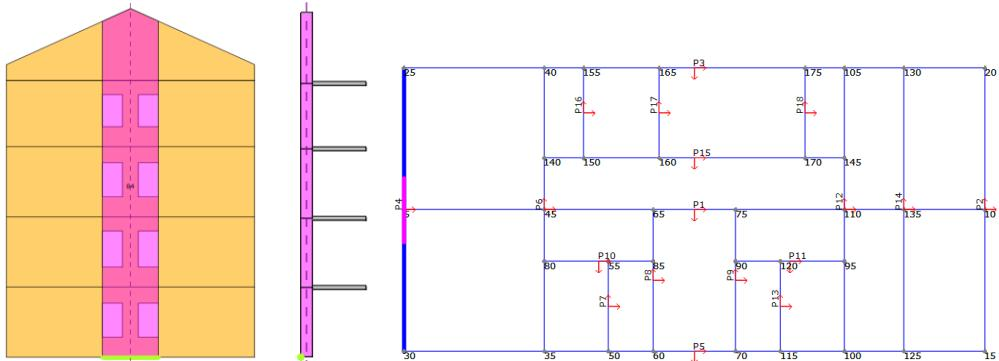
Slika 92. Geometrija prepostavljenog bloka mehanizma otkazivanja tipa E primjer 1 (lijevo), prikaz položaja zgloba (u sredini), polojaj zida u konstrukciji (desno)
