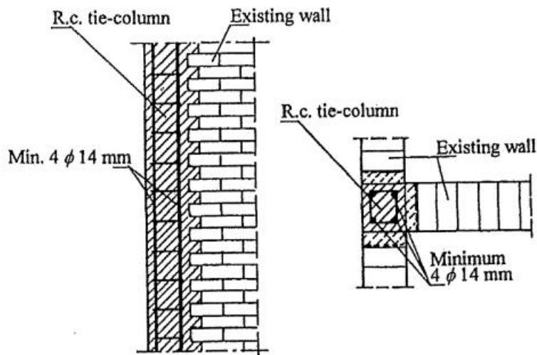
Slika 31. Pojačanje zidova ugradnjom AB vertikalnih serklaža [13]
