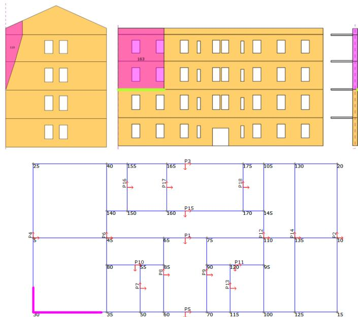
Slika 86. Geometrija prepostavljenog bloka mehanizma otkazivanja B1 primjer 2 (gore lijevo i u sredini), prikaz položaja zgloba (gore desno), položaj zida u konstrukciji (dolje)
