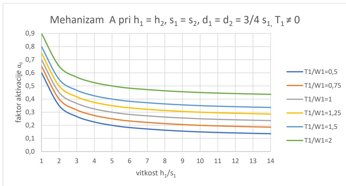
Slika 41. Faktor aktivacije za mehanizam otkazivanja A - slučaj 4
