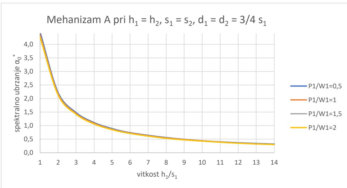
Slika 36. Spektralno ubrzanje za mehanizam otkazivanja A - slučaj 1
