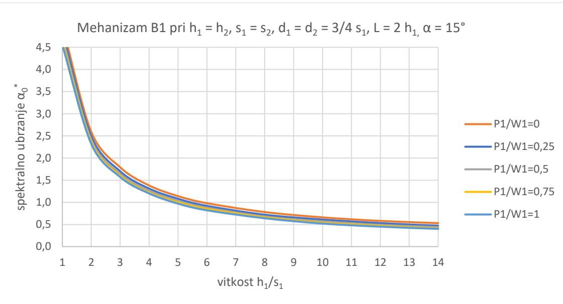
Slika 51. Spektralno ubrzanje za mehanizam tipa B1 - slučaj 1
