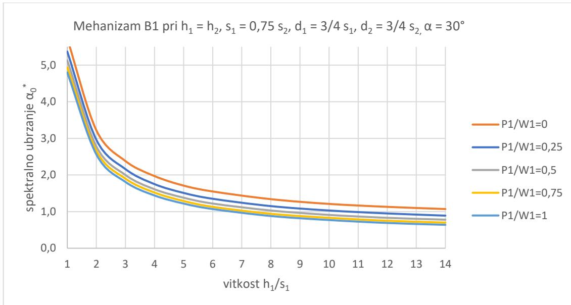
Slika 63. Spektralno ubrzanje za mehanizam tipa B1 - slučaj 7
