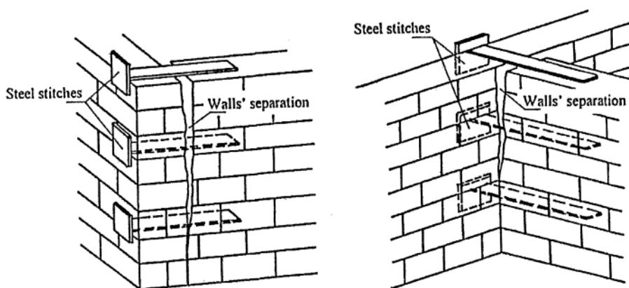
Slika 30. Pojačanje ugla pomoću čeličnih ploča [13]
