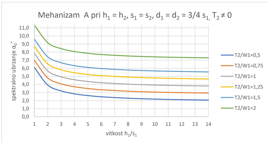
Slika 44. Spektralno ubrzanje za mehanizam otkazivanja A - slučaj 5
