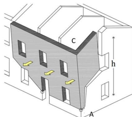
Slika 45. Shematski prikaz mehanizma otkazivanja tipa B1 [16]
