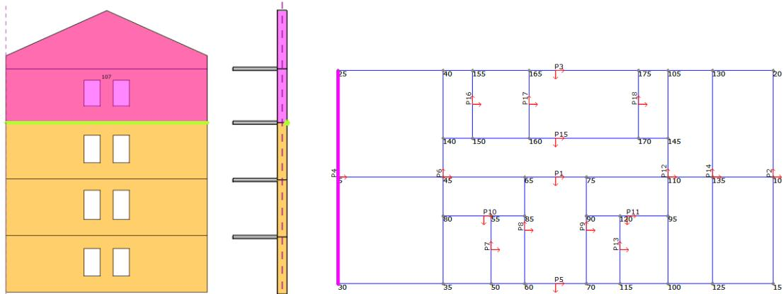
Slika 81. Geometrija pretpostavljenog bloka mehanizma otkazivanja A primjer 1 (lijevo), prikaz položaja zgloba (u sredini), položaj zida u konstrukciji (desno)
