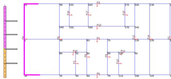
Slika 87. Geometrija prepostavljenog bloka mehanizma otkazivanja B2 (gore), prikaz položaja zgloba (dolje lijevo), položaj zida u konstrukciji (dolje desno)
