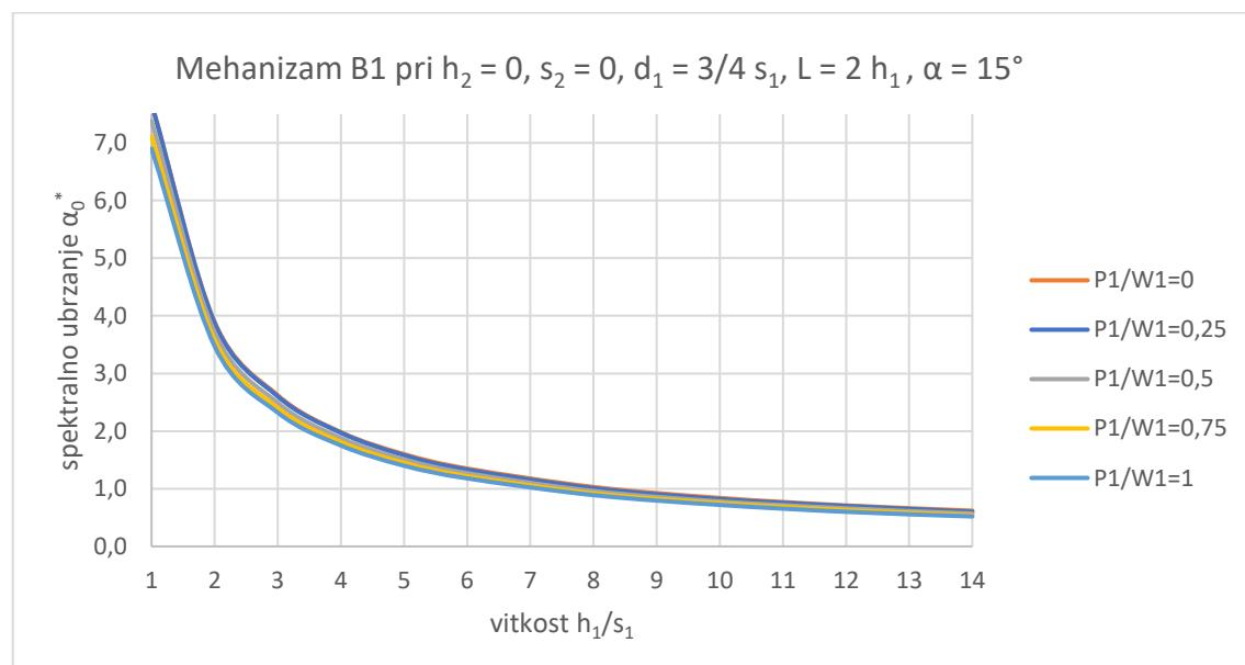
Slika 57. Spektralno ubrzanje za mehanizam tipa B1 - slučaj 4
