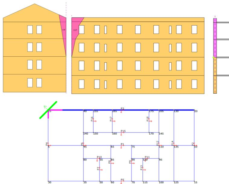
Slika 89. Geometrija pretpostavljenog bloka mehanizma otkazivanja C primjer 2 (gore lijevo i u sredini), prikaz položaja zgloba (gore desno), položaj u konstrukciji (dolie)
