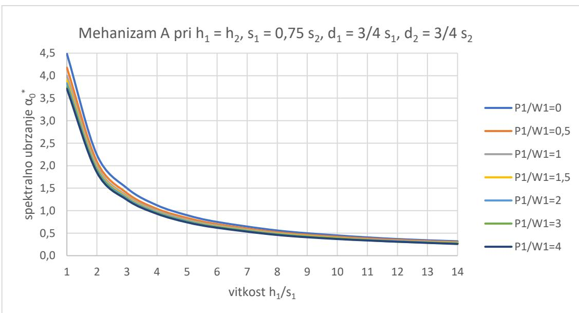
Slika 40. Spektralno ubrzanje za mehanizam otkazivanja A - slučaj 3
