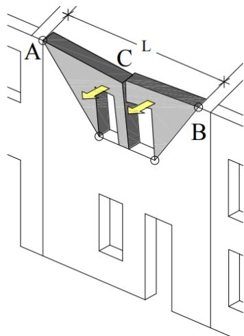
Slika 64. Shematski prikaz mehanizma otkazivanja tipa G [16]
