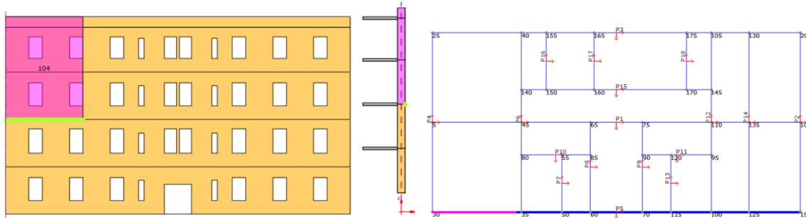
Slika 84. Geometrija pretpostavljenog bloka mehanizma otkazivanja A primjer 4 (lijevo), prikaz položaja zgoba (u sredini), položaj zida u konstrukciji (desno)
