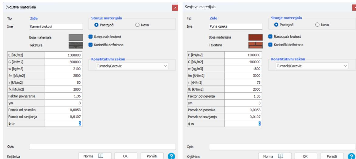
Slika 78. Materijalne карактеристике nosivog zida (lijevo) i pregradnog zida (desno)
