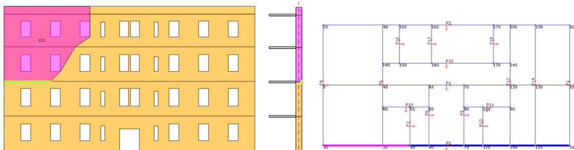
Slika 91. Geometrija prepostavljenog bloka mehanizma otkazivanja D (lijevo), prikaz položaja zgloba (u sredini), položaj zida u konstrukciji (desno)
