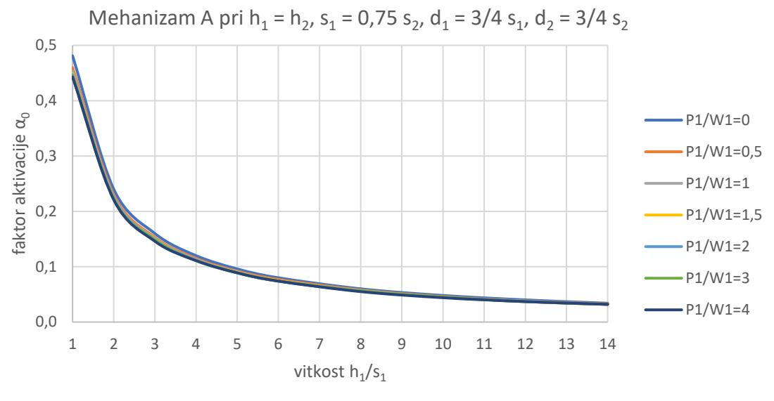
Slika 39. Faktor aktivacije za mehanizam otkazivanja A - slučaj 3
