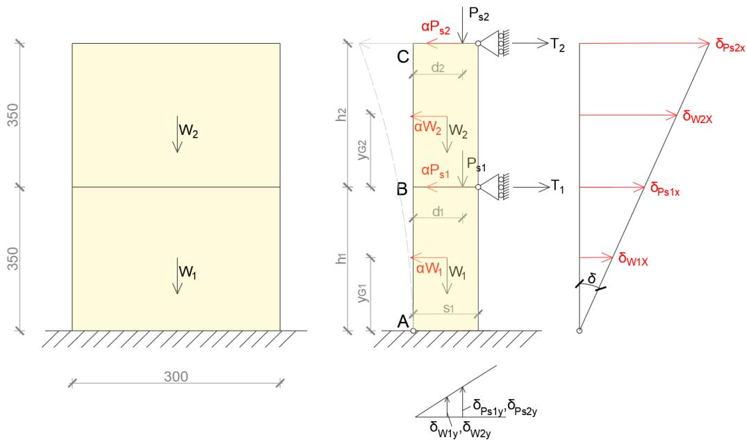
Slika 34. Geometrija zida i prepostavljeni mehanizam tipa A
