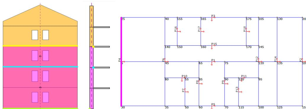
Slika 96. Geometrija prepostavljenog bloka mehanizma otkazivanja tipa F primjer 2 (lijevo), prikaz položaja zgloba (u sredini), položaj zida u konstrukciji (desno)
