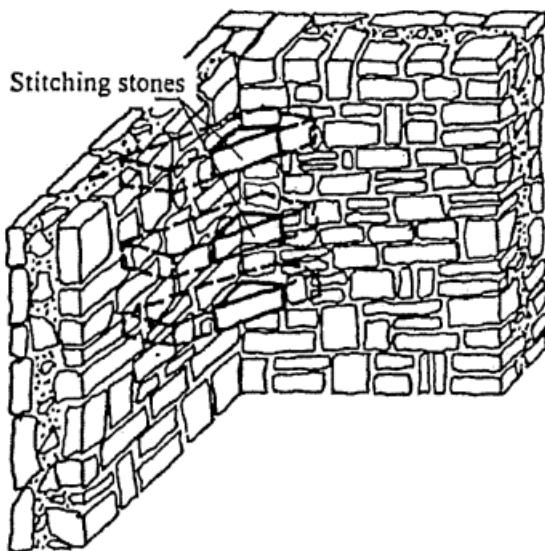
Slika 29. Pojačanje ugla pomoću spojnih kamenih blokova [13]
