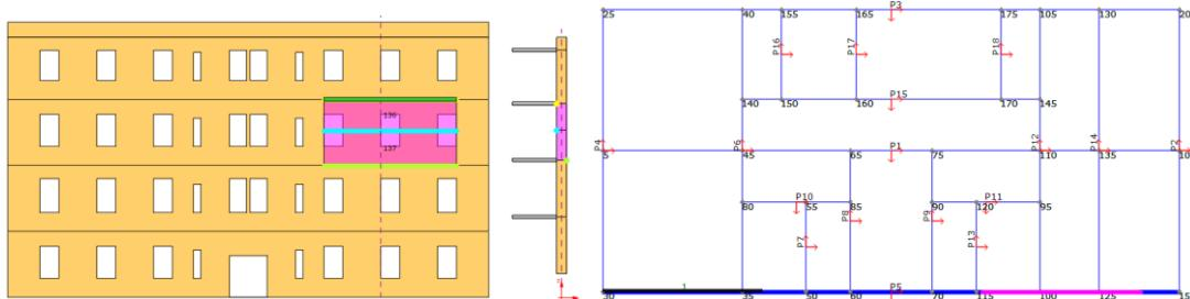
Slika 109. Geometrija prepostavljenog bloka mehanizma otkazivanja tipa F primjer 11 (lijevo), prikaz položaja zgoba (u sredini), položaj zida u konstrukciji (desno)
