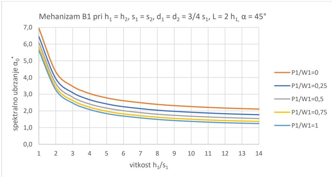
Slika 55. Spektralno ubrzanje za mehanizam tipa B1 - slučaj 3
