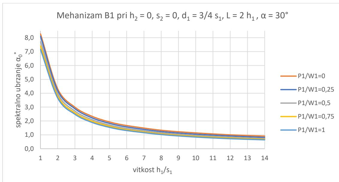
Slika 59. Spektralno ubrzanje za mehanizam tipa B1- slučaj 5
