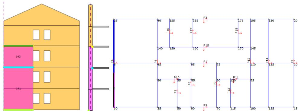
Slika 97. Geometrija prepostavljenog bloka mehanizma otkazivanja tipa F primjer 3 (lijevo), prikaz položaja zgoba (u sredini), položaj zida u konstrukciji (desno)
