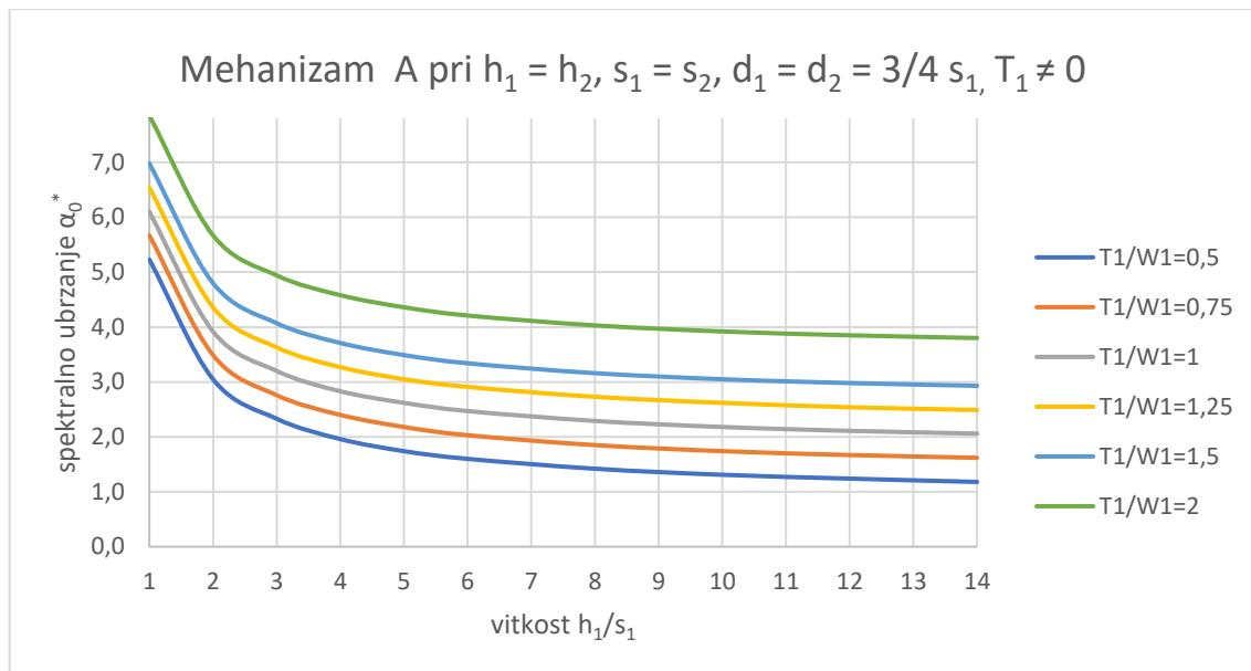
Slika 42. Spektralno ubrzanje za mehanizam otkazivanja A - slučaj 4
