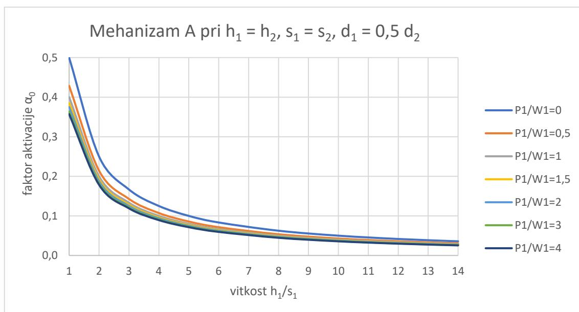
Slika 37. Faktor aktivacije za mehanizam otkazivanja A - slučaj 2
