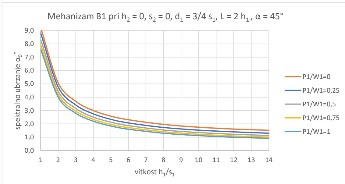
Slika 61. Spektralno ubrzanje za mehanizam tipa B1 - slučaj 6
