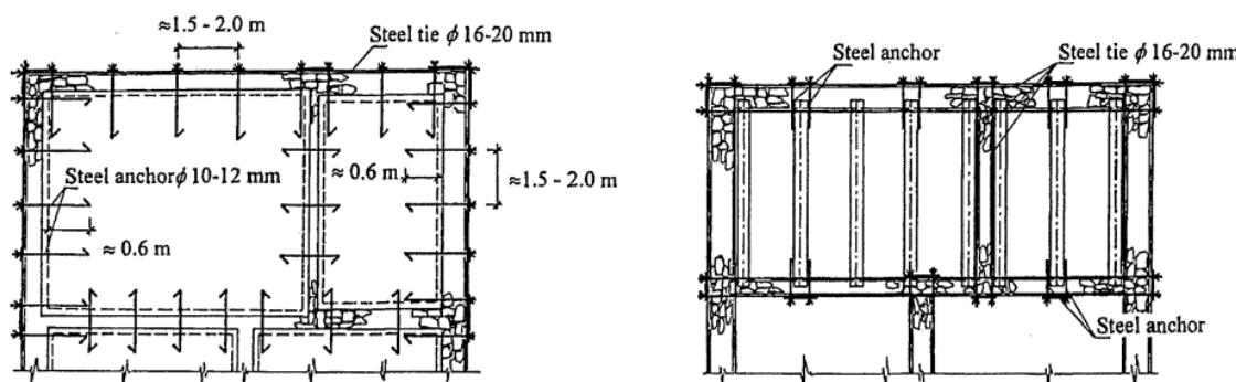
Slika 25. Pojačanja stropne konstrukcije: nova AB ploča (lijevo), zadržavanje drvene stropne konstrukcije i ugradnja zatega (desno) [13]
