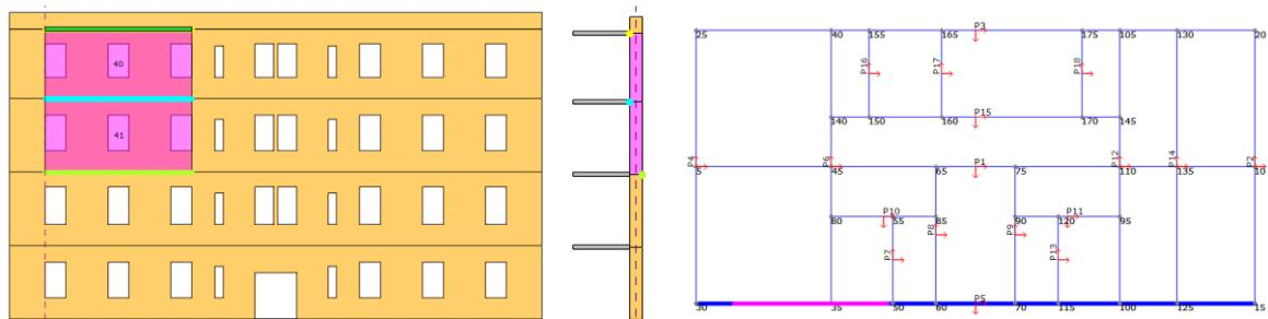
Slika 95. Geometrija prepostavljenog bloka mehanizma otkazivanja tipa F primjer 1 (lijevo), prikaz položaja zgloba (u sredini), položaj zida u konstrukciji (desno)
