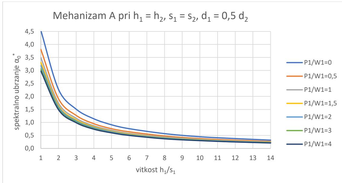
Slika 38. Spektralno ubrzanje za mehanizam otkazivanja A - slučaj 2
