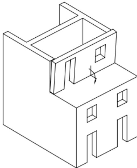
Slika 17. Prevrtanje zida nadogradnje - shema [2]
