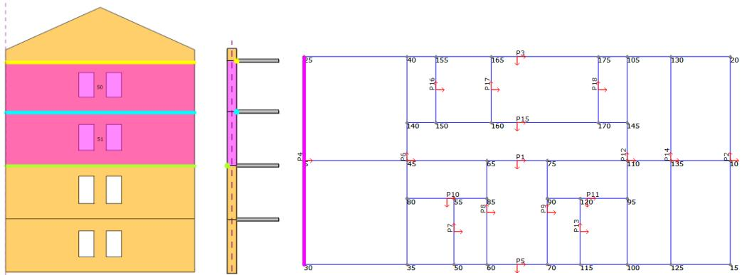
Slika 99. Geometrija prepostavljenog bloka mehanizma otkazivanja tipa F primjer 4 (lijevo), prikaz položaja zglobova (u sredini), položaj zida u konstrukciji (desno)
