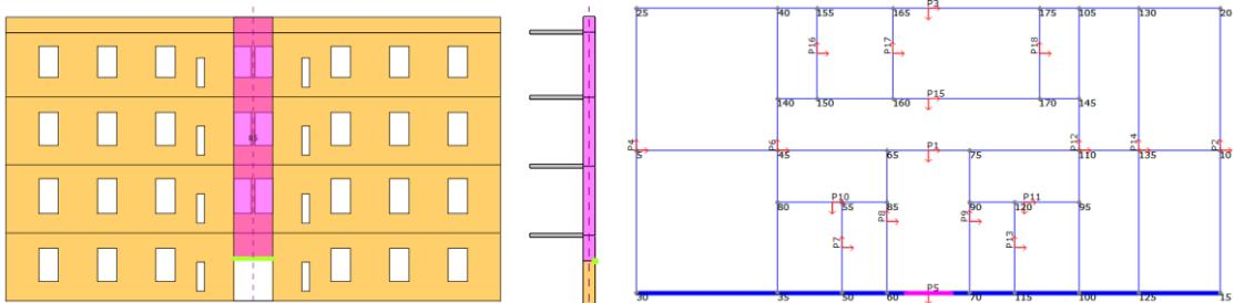
Slika 94. Geometrija prepostavljenog bloka mehanizma otkazivanja tipa E primjer 3 (lijevo), prikaz položaja zgloba (u sredini), položaj zida u konstrukciji (desno)
