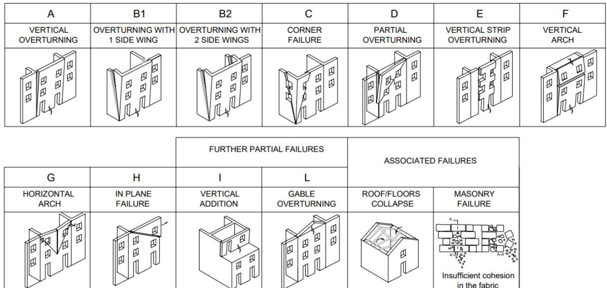
Slika 1. Osnovni mehanizmi otkazivanja zidova izvan ravnine [2]
