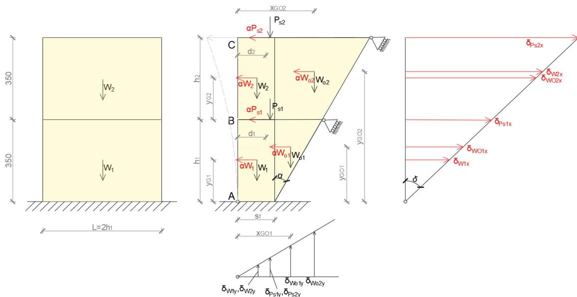
Slika 49. Geometrija zida i prepostavljeni mehanizam tipa B1
