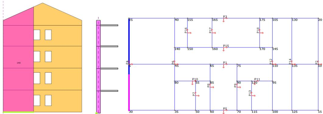
Slika 93. Geometrija prepostavljenog bloka mehanizma otkazivanja tipa E primjer 2 (lijevo), prikaz položaja zgloba (u sredini), položaj zida u konstrukciji (desno)
