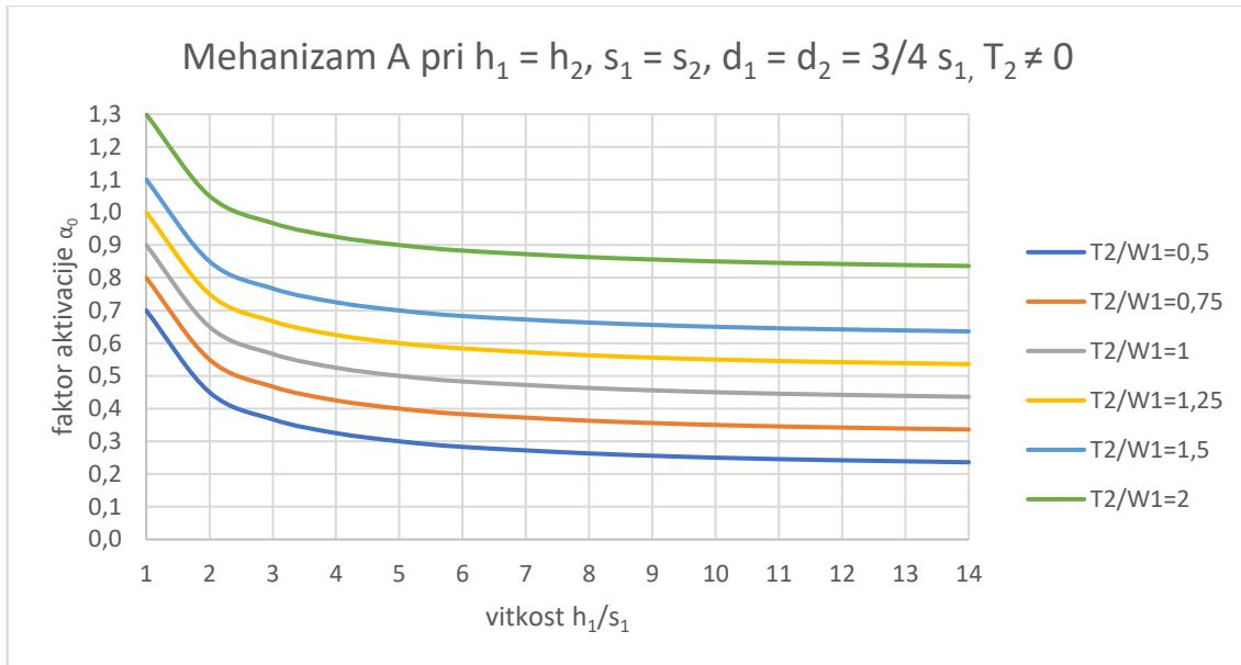
Slika 43. Faktor aktivacije za mehanizam otkazivanja A – slučaj 5
