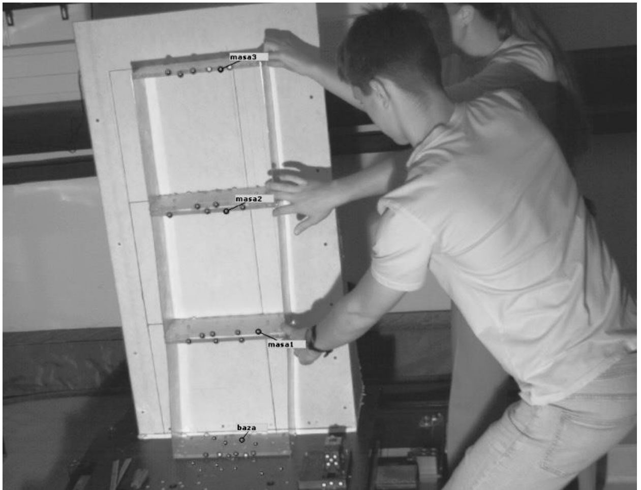
Slika 27. Istovremeno otpuštanje konstrukcije u 1. tonu
