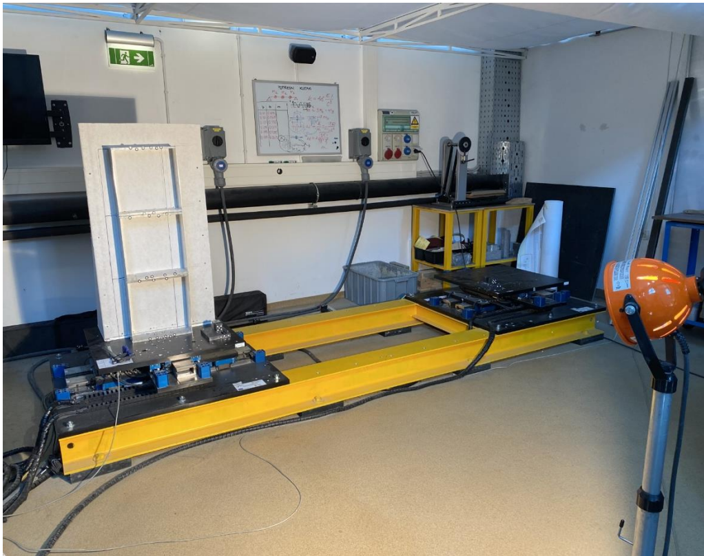
Slika 12. Potresna platforma „Quanser ST-III“ na Građevinskom fakultetu u Rijeci
