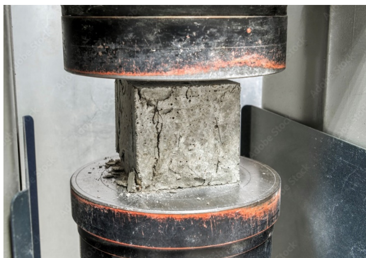
Slika 14: Ispitani uzorak betonske kocke [19]
