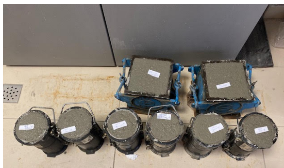
Slika 19: Izrada mješavina betona (u kalupu), (izvor: vlastita fotografija)
