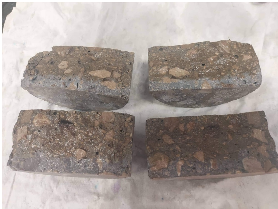
Slika 26: Vidljiv prodor klorida u ispitne uzorke – srebrni nitrat (izvor: vlastita fotografija)
