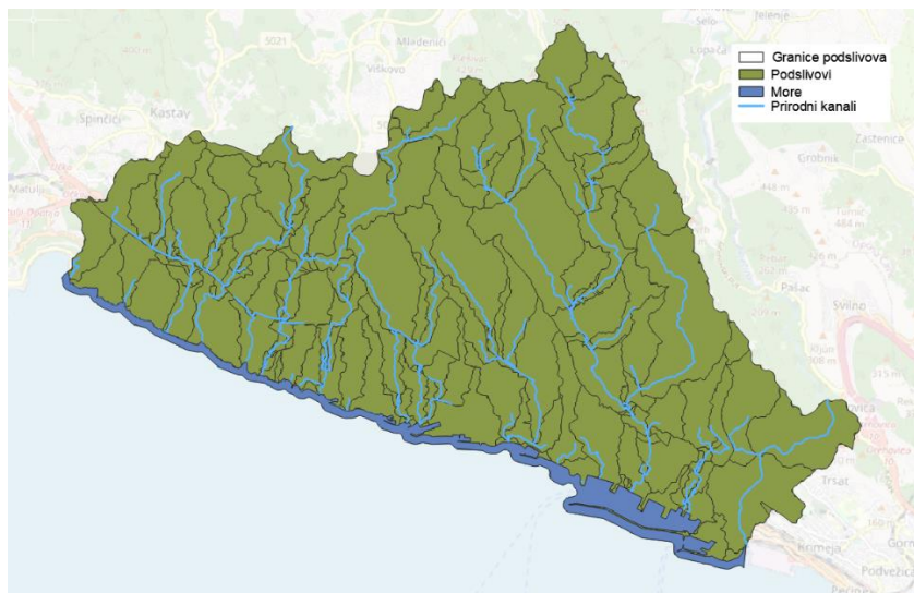
Slika 30: Generirani podslivovi i smjerovi otjecanja oborinskih voda unutar obuhvata
