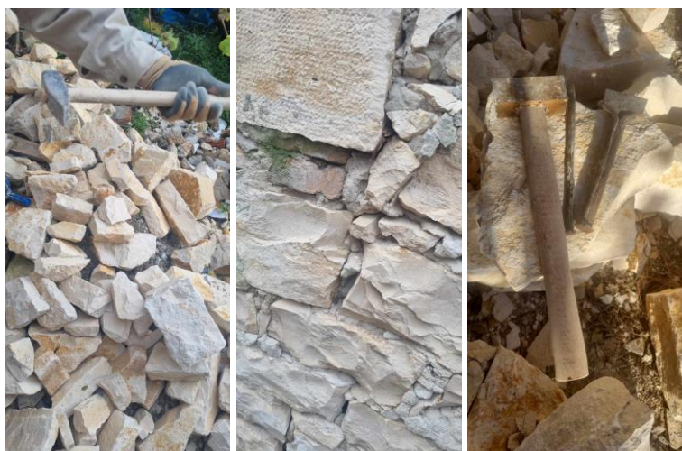
Slika 34: Tradicionalno klesanje kamena u Rovinju (foto autorica, 2023.)
