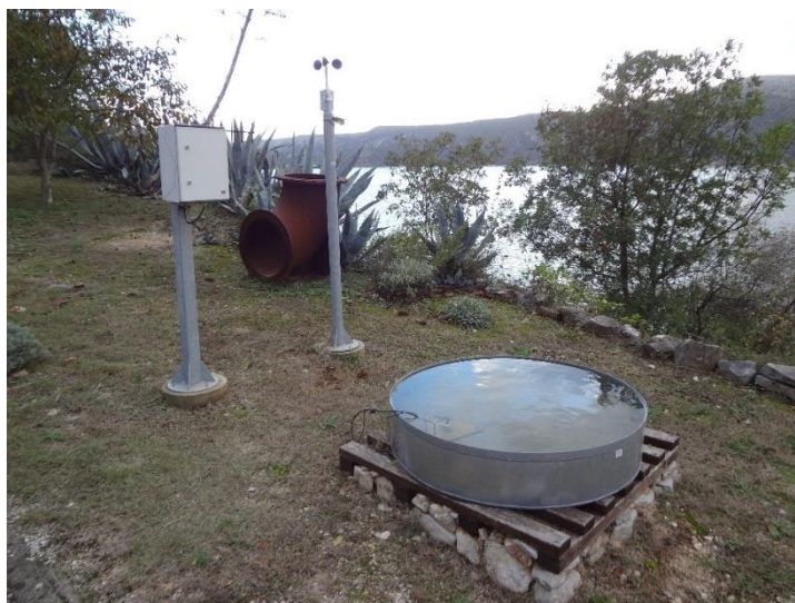
Slika 3.1.3. Automatski isparitelj klase A na lokaciji Vransko jezero-Cres (izradio autor)
