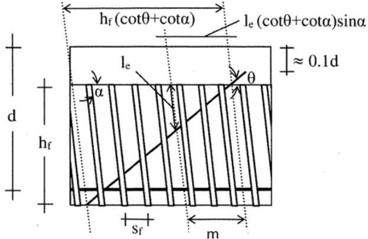
Slika 32: Lamele koje prelaze preko pukotine od poprečnih sila [3]
