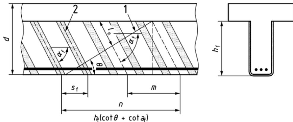
Slika 35: Ilustracija ABR spona koje prelaze preko pukotine od poprečnih sila; 1 = pukotina od poprečnih sila, 2 = trake s nagibom  $\alpha_f$ ,  $m$  = trake s  $l_{bf} < l_{bf,\max,k}$ ,  $n$  = trake koje sijeku pukotinu od poprečnih sila [4]
