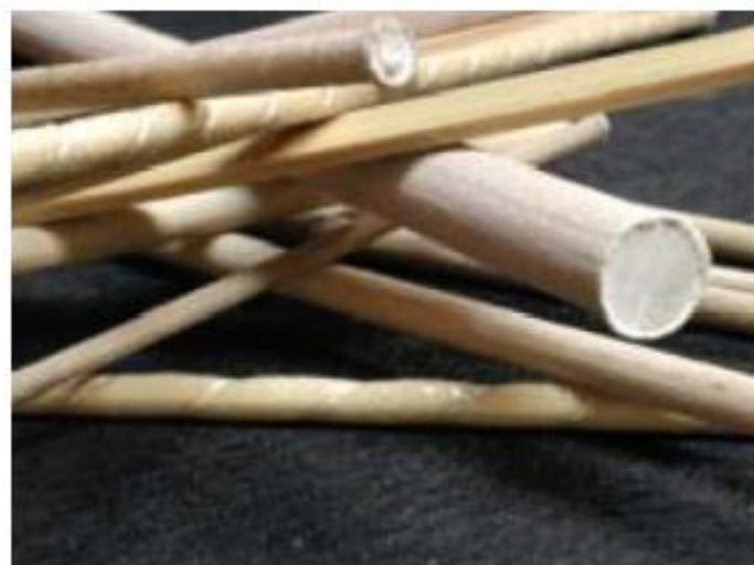
Slika 4: Ugljična vlakna u polimernim šipkama [5]
