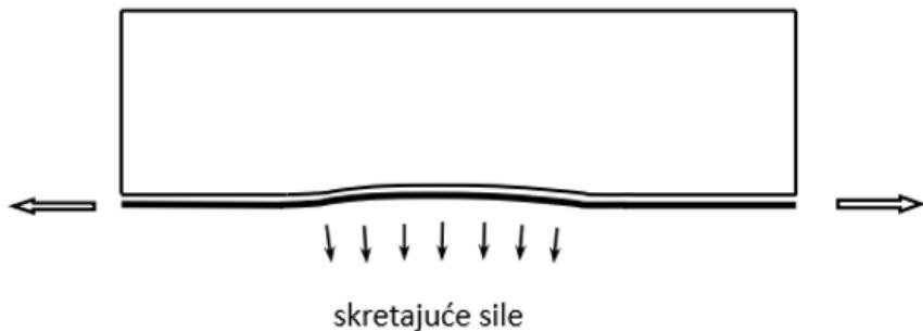
Slika 9: Odvajanje uzrokovano neravninama betonske površine [1]
