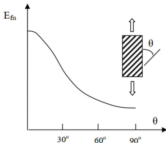
Slika 21: Ovisnost FRP modula elastičnosti,  $E_{fu}$ , o orientaciji vlakana [1]
