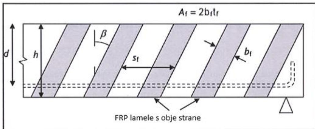
Slika 29: Opće oznake za pojačanje na poprečne sile [2]
