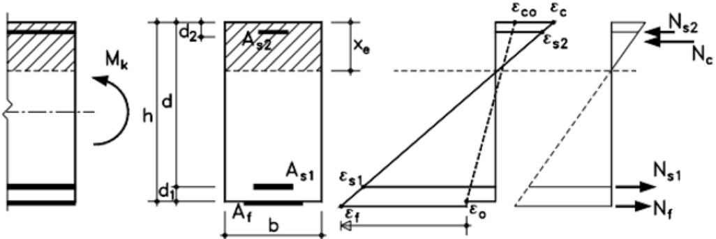
Slika 10: Linearno elastični proračun raspucalog presjeka [1]
