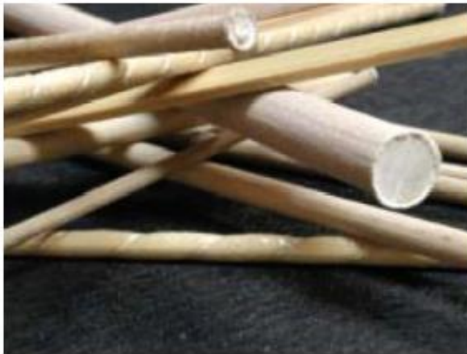
Slika 4: Ugljična vlakna u polimernim šipkama [5]
