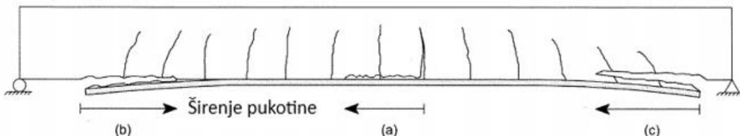
Slika 17: Načini otkazivanja pri odvajaju betonskog elementa s vanjskim spojem FRP-a:
