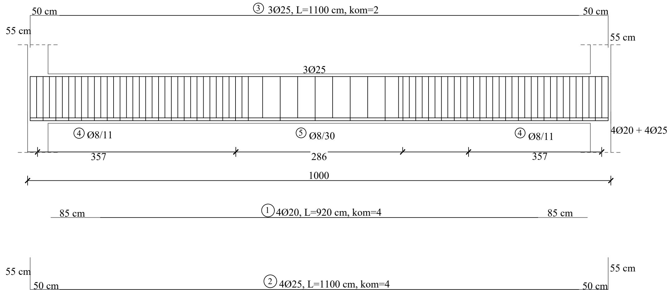
POPREČNI PRESJEK GREDE M 1:20
