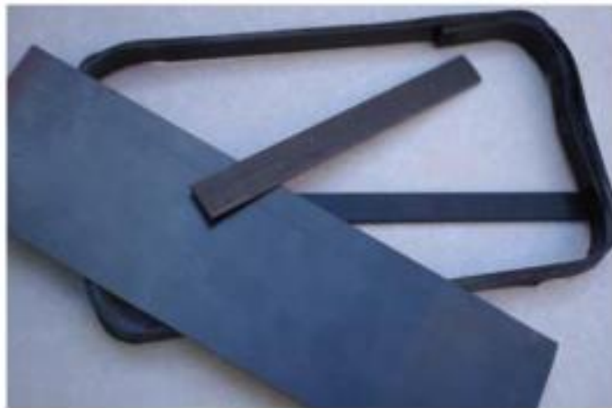
Slika 2: FRP trake i lamele za pojačanje [6]
