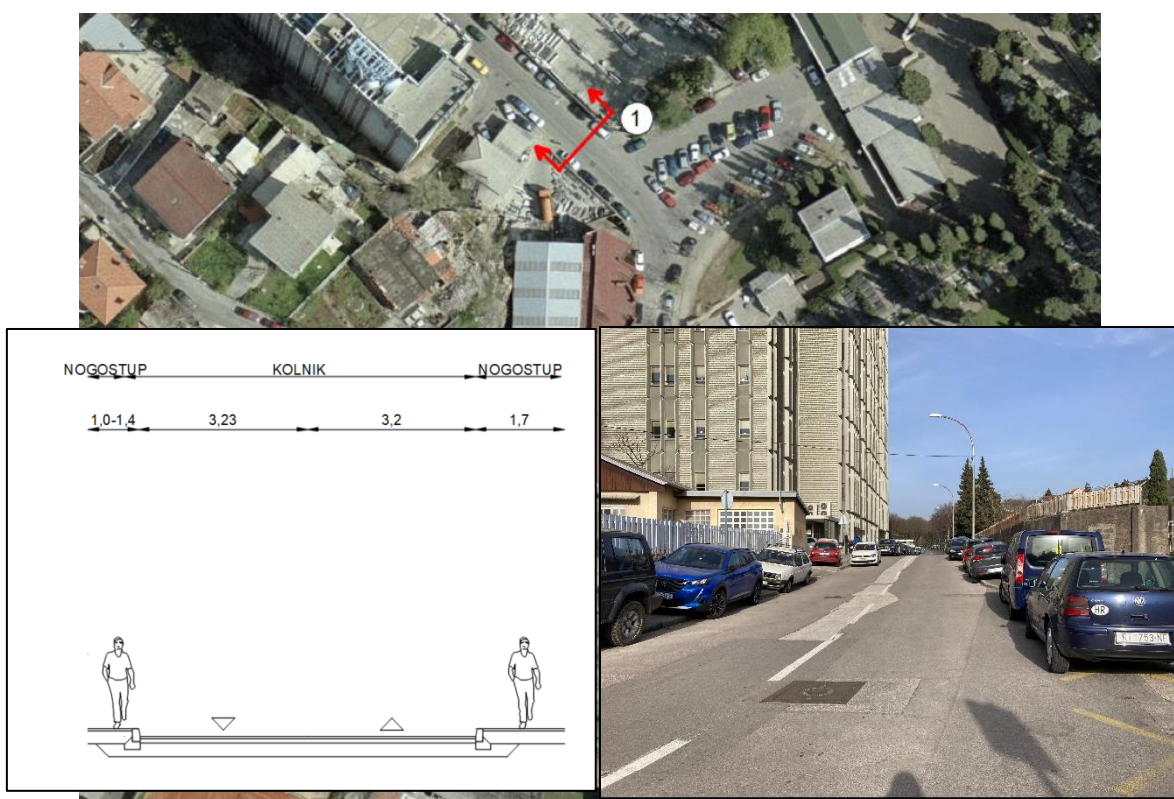
Slika 7: Poprečni presjek Ulice Petra Kobeka 1
