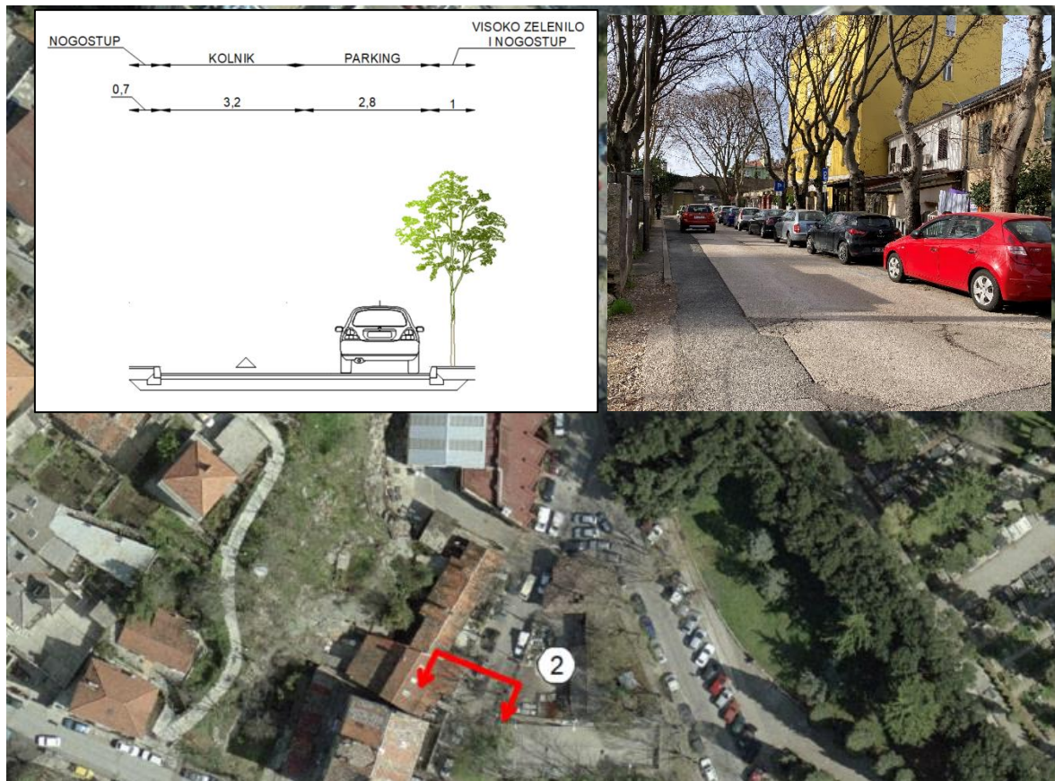
Slika 8: Poprečni presjek Ulice Petra Kobeka 2
