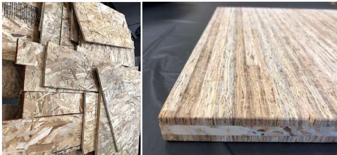
Slika 7: Prerada CLT otpada (slika lijevo) u nove reciklirane panele (slika desno) (izvor: https://www.trilliumpacific.com/clt-recycled , 26.05.2024.)
