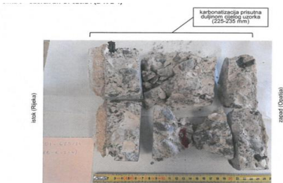
Slika 36 Prikaz prolaska karbonata kroz cijeli ispitani uzorak [11]
