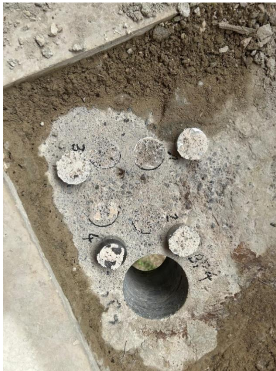
Slika 48 Prikaz sloma uslijed pull off ispitivanja
