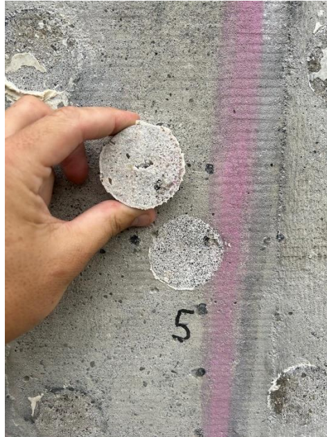
Slika 58 Prikaz sloma prilikom ispitivanja pull off metodom na poziciji B-K-1-1 (ispitni uzorak broj 5)
