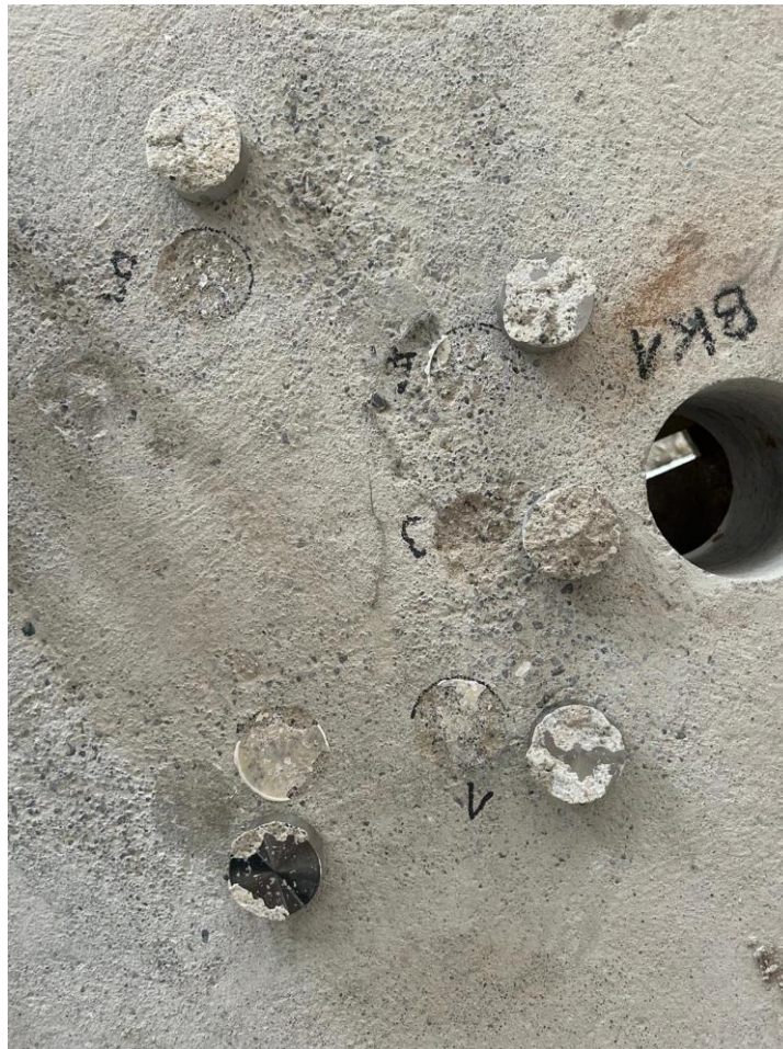
Slika 51 Prikaz sloma uslijed ispitivanja pull off metodom na lokaciji B-K1-1
