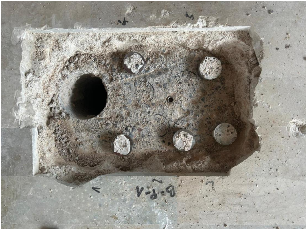
Slika 60 Prikaz sloma prilikom ispitivanja pull off metodom na lokaciji B-P-1
