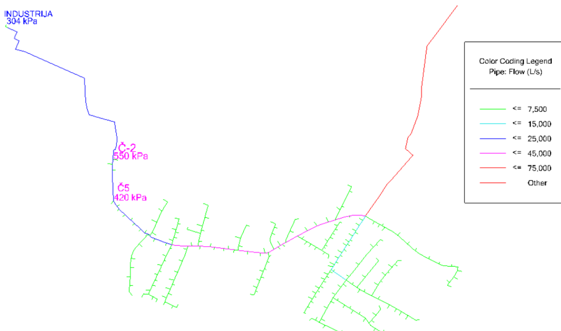
Slika 51. Prikaz radnih tlakova na sustavu za vrijeme gašenja požara u industriji
