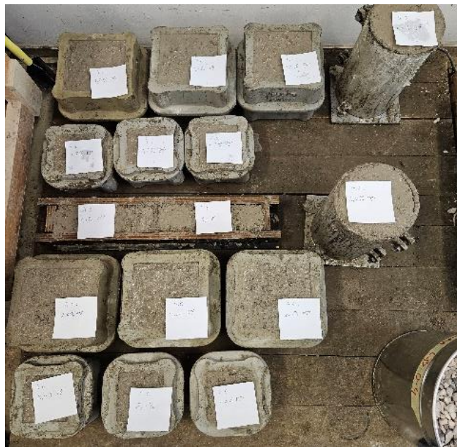
Slika 13. Ugrađene betonske mješavine u kalupe (Autor: Nikolina Edjut)
