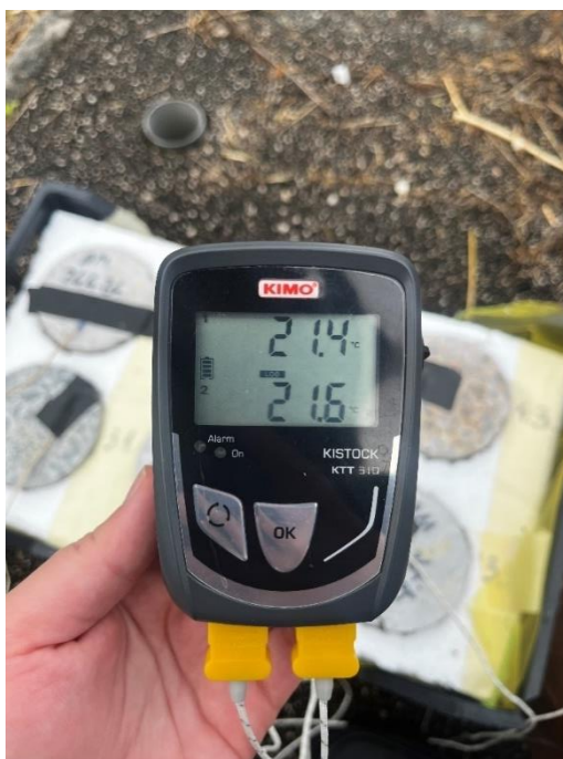
Slika 19: Uređaj za mjerenje temperature uzoraka (izvor: vlastita fotografija)
