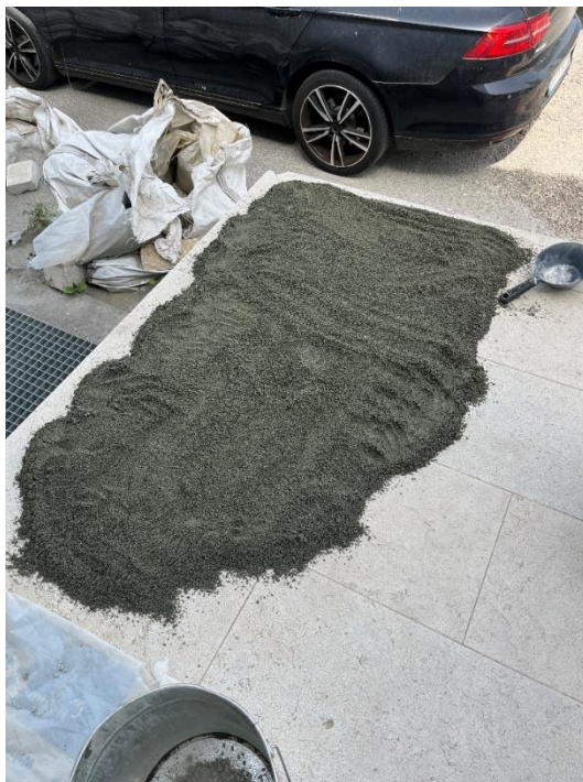
Slika 2: Sušenje eruptivnog agregata frakcije 0-4 mm (izvor: vlastita fotografija)
