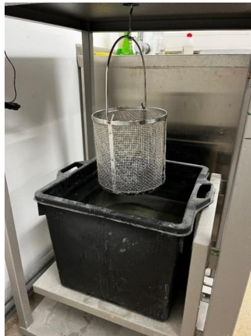
Slika 10: Vaganje agregata na zraku (izvor: vlastita fotografija)
