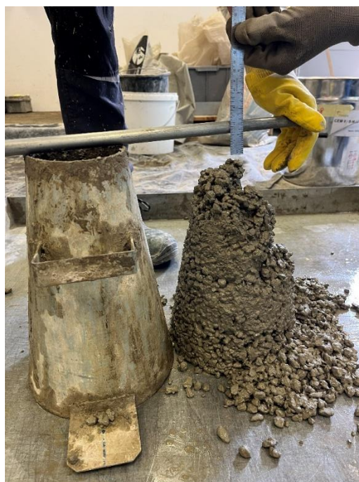
Slika 13: Ispitivanje konzistencije svježeg betona slijeganjem (izvor: vlastita fotografija)
