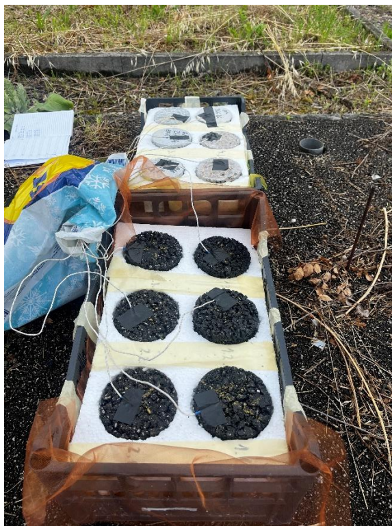
Slika 20: Postavljene sonde u šupljine uzoraka (izvor: vlastita fotografija)
