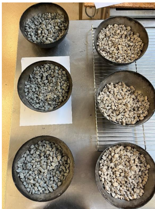
Slika 15: Izvagani materijali (lijevo: s eruptivnim agregatom; desno: s vapnenačkim agregatom) (izvor: vlastita fotografija)
