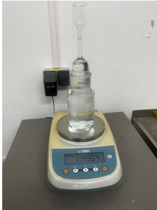
Slika 6: Piknometar ispunjen vodom do označenog nivoa (izvor: vlastita fotografija)
