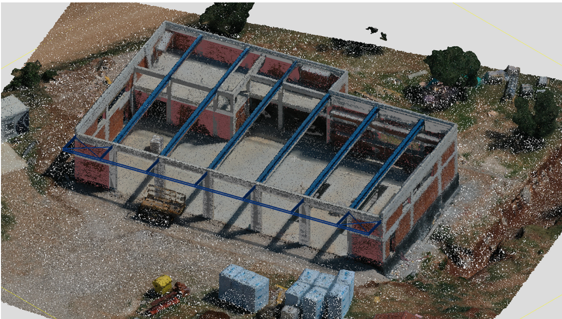
Slika 26 Preklapanje oblaka točaka i BIM modela Građevine 1
