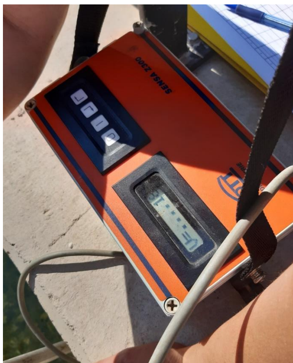
Slika 14. Uređaj provodi mjerenje dok ne stabilizira očitavanje i prikaže konačnu brzinu (Slika autora.)
