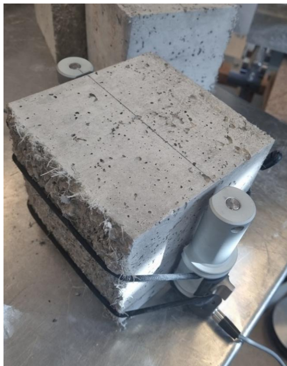
Slika 27: Ekstenzometri montirani i pričvršćeni na uzorak betona s vlaknima
