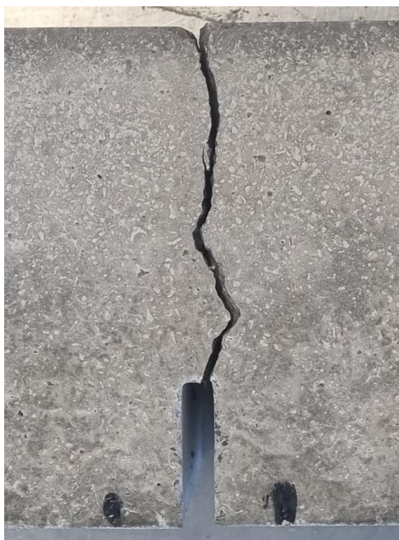
Slika 48: Ploha sloma uzorka s vunениm vlaknima
