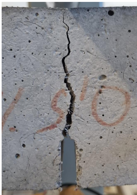
Slika 49: Ploha sloma uzorka s PP vlaknima
