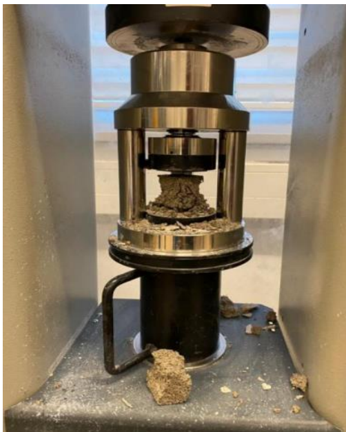
Slika 18. Oblik sloma uzorka nakon tlačnja
