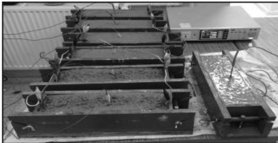
Slika 7. Njega betona korištenjem električne energije[19]
