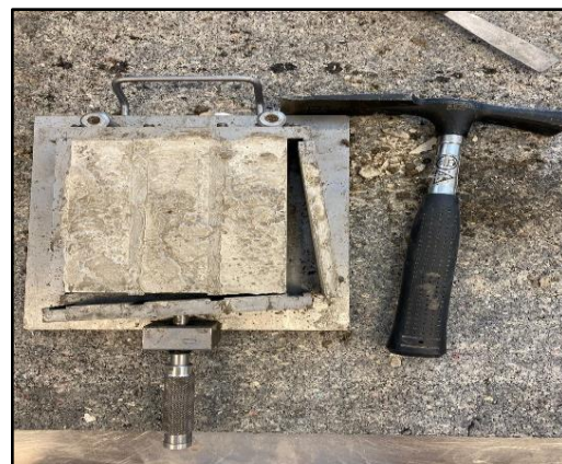
Slika 12. Odvajanje prizmi od kalupa [20]
