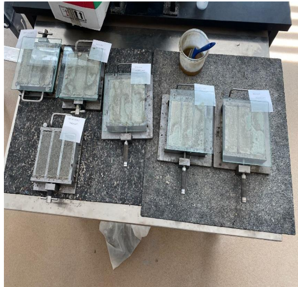
Slika 10. Cementni mort u kalupima [20]
