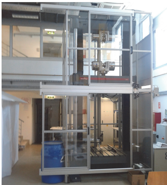
Slika 4. Univerzalni tlačno-vlačni uređaj za ispitivanje (kidalica)
