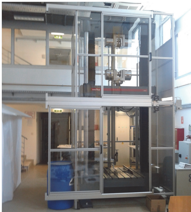
Slika 4. Univerzalni tlačno-vlačni uređaj za ispitivanje (kidalica)
