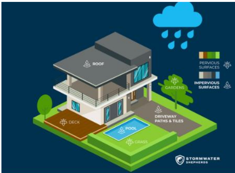
Slika 2: Primjer propusnih i nepropusnih površina [3].
