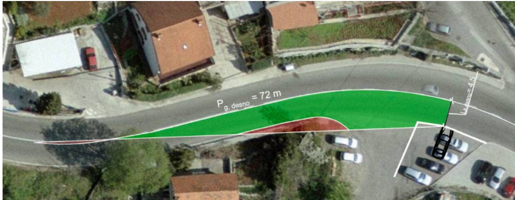
Slika 16 - Grafički prikaz zaustavne preglednosti prilikom skretanja udesno sa sporednog smjera prema HR modelu
