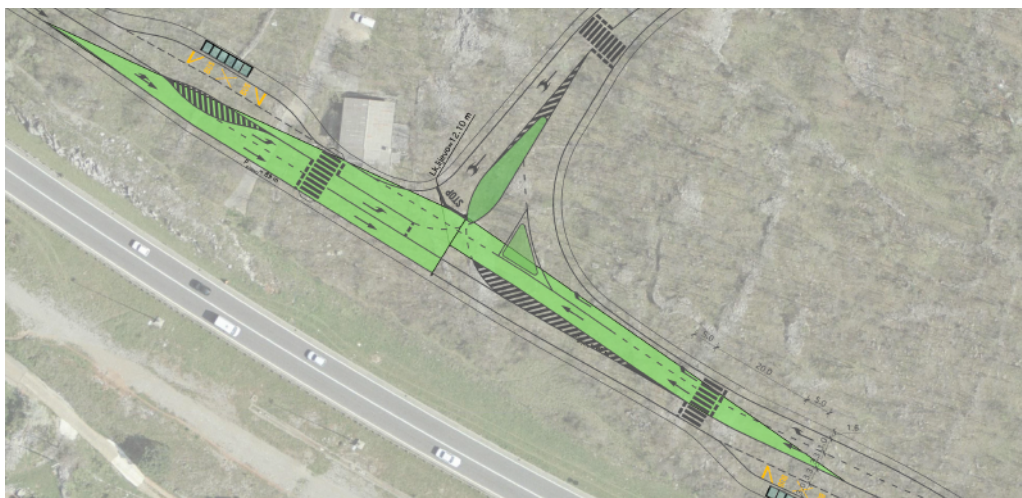
Slika 46 - R3 Varijanta 1 - Grafički prikaz zaustavne preglednosti prilikom skretanja ulijevo sa sporednog smjera prema HR modelu
